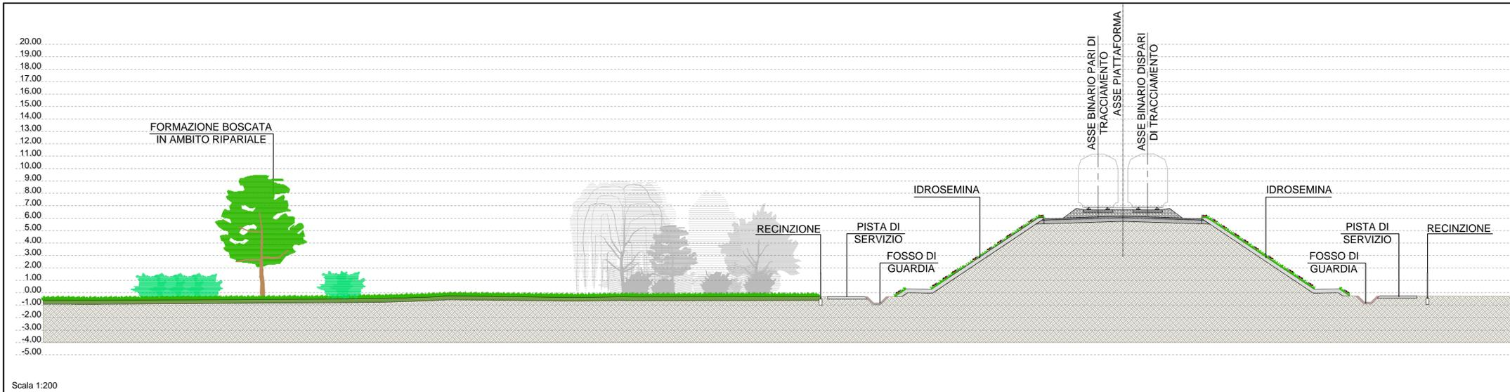
SEZIONE TIPO RILEVATO CON MURO DI CONTENIMENTO
