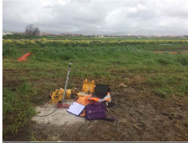
Figura 7.15 – Fase di esecuzione del carotaggio sismico down-hole.
