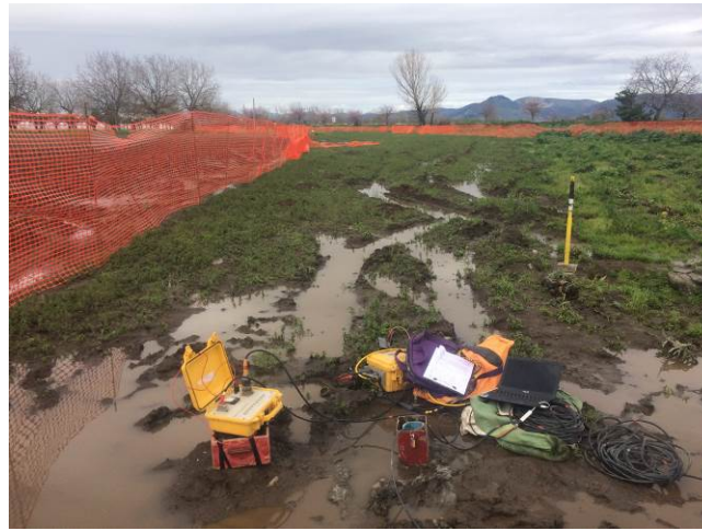
Figura 7.19 – Fase di esecuzione del carotaggio sismico down-hole.
