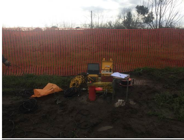
Figura 7.29 – Fase di esecuzione del carotaggio sismico down-hole.
