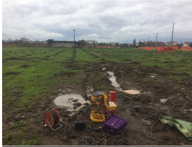
Figura 7.35 – Fase di esecuzione del carotaggio sismico down-hole.
