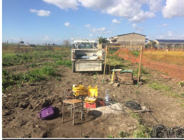
Figura 7.31 – Fase di esecuzione del carotaggio sismico down-hole.
