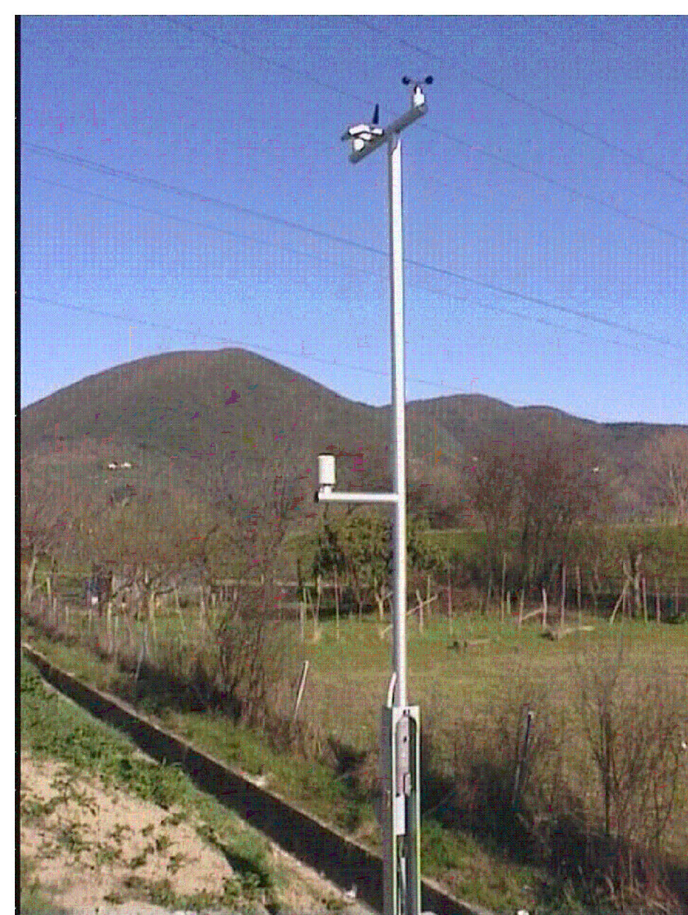
Postazione rilevamento meteo ambientale su palo basculante in acciaio zincato a caldo, con altezza minima 5 metri e con guancia di bilanciamento
