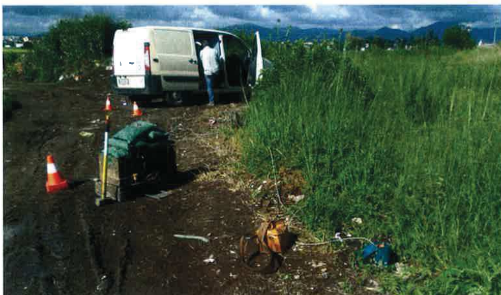
Figura 5.2 – Il geofono da foro tridimensionale Geostuff all'interno del foro di sondaggio ed il dispositivo di energizzazione utilizzato per la generazione delle onde S nella prova down-hole S23a.
