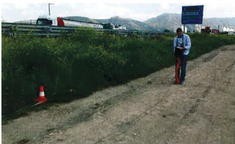
Figura 4.2 – Fasi di esecuzione del rilievo elettromagnetico con strumentazione EM34 Geonics, in corrispondenza della piazzola del sondaggio S53a.
