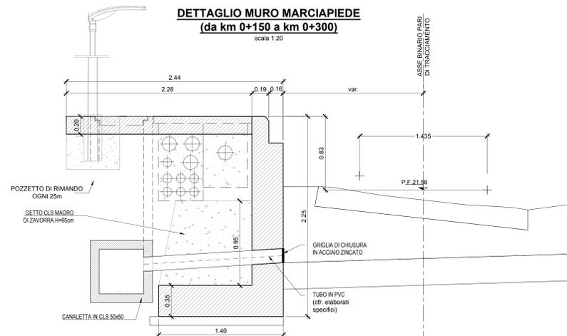
**DETTAGLIO MURO MARCIAPIEDE IN CORRISPONDENZA DEL POZZETTO (da km 0+150 a km 0+300)**
