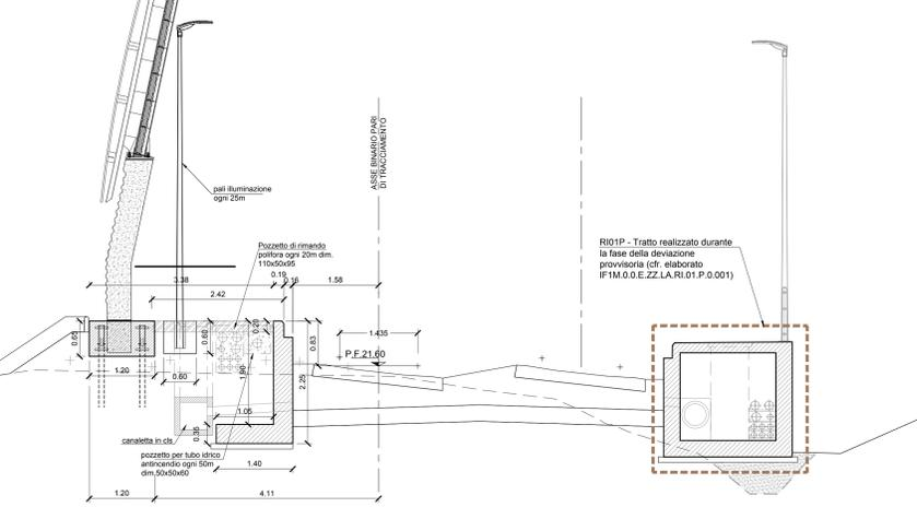
**DETTAGLIO MURO MARCIAPIEDE (da km 0+150 a km 0+300)**
