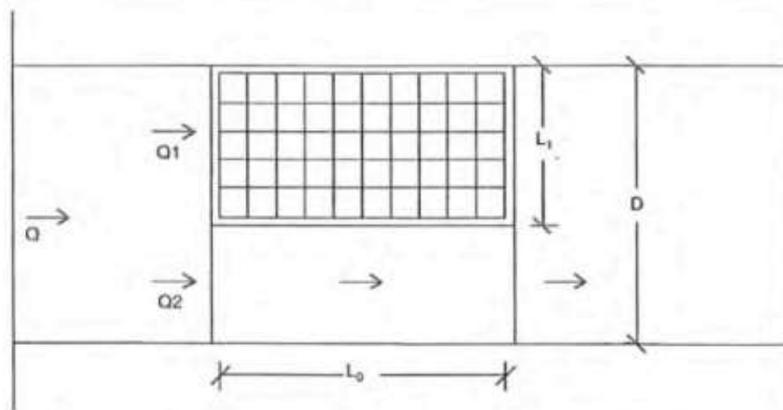
**Figura 14 : schema di deflusso in prossimità di una caditoia**
