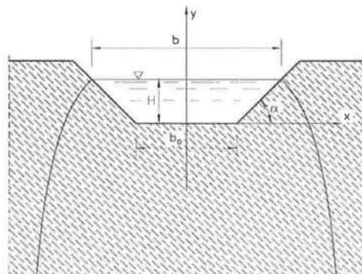
Figura 10 : Schema del funzionamento disperdente del fosso disperdente.
