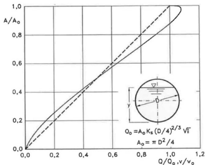
Figura 8 : Andamento della portata in funzione della sezione liquida della condotta.
