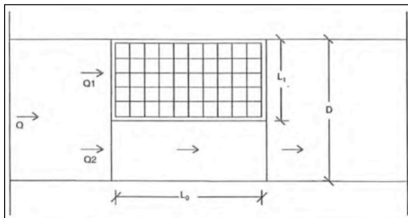
**Figura 11 : schema di deflusso in prossimità di una caditoia**
