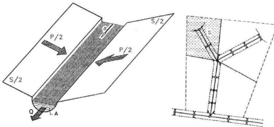
Figura 7 : Schema per il calcolo delle portate con il metodo dell'invaso.
