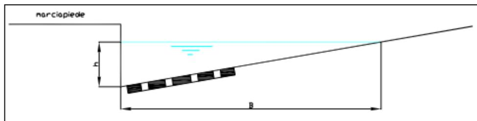
Figura 12 : Schema della cunetta stradale
