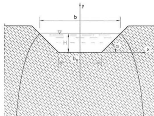
**Figura 14 : Schema del funzionamento del fosso disperdente.**
