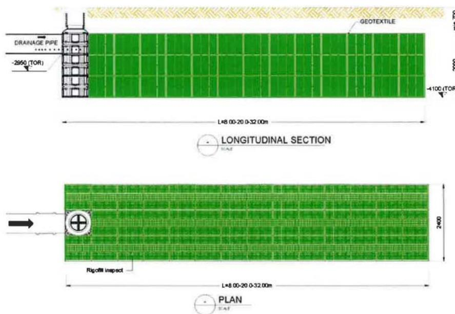
Figura 16 : Tipologico di trincea drenante con moduli in materiale plastico
