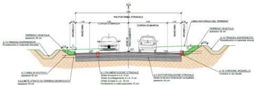
Figura 2: Sezione tipologica in rilevato
