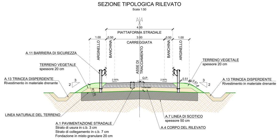
**A.1 DETTAGLIO PAVIMENTAZIONE STRADALE**
