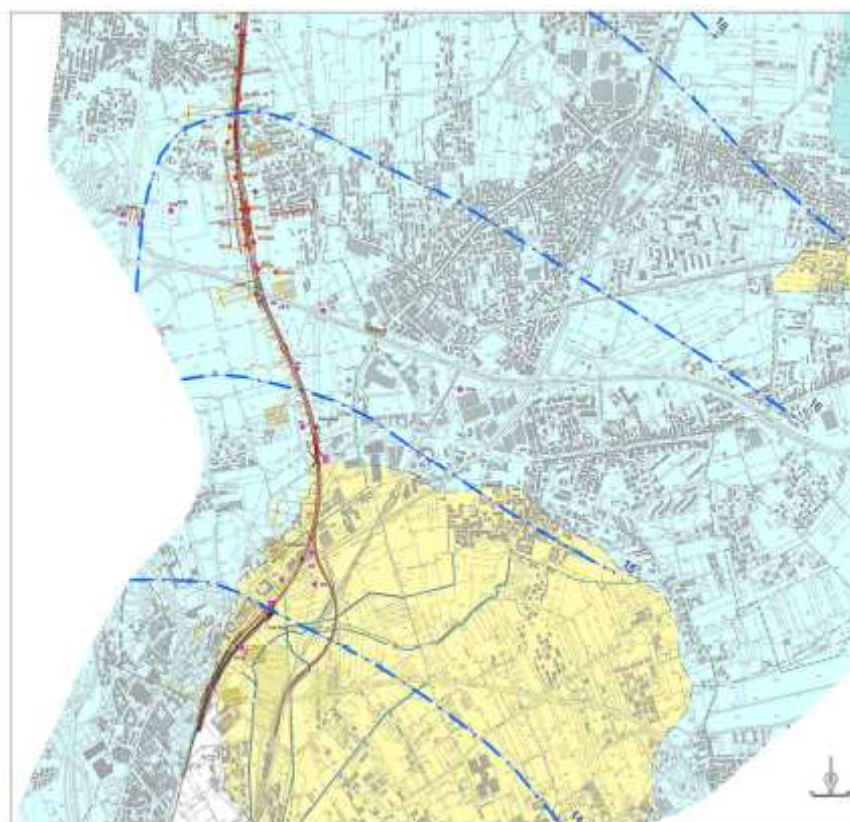
Figura 8 – Carta Idrogeologica con rappresentazione a linee isopieze (quote in m s.l.m.) della falda idrica, estratta dal Progetto Definitivo della Variante ferroviaria Canello- Napoli (stralcio relativo alla zona interessata dal presente studio)
