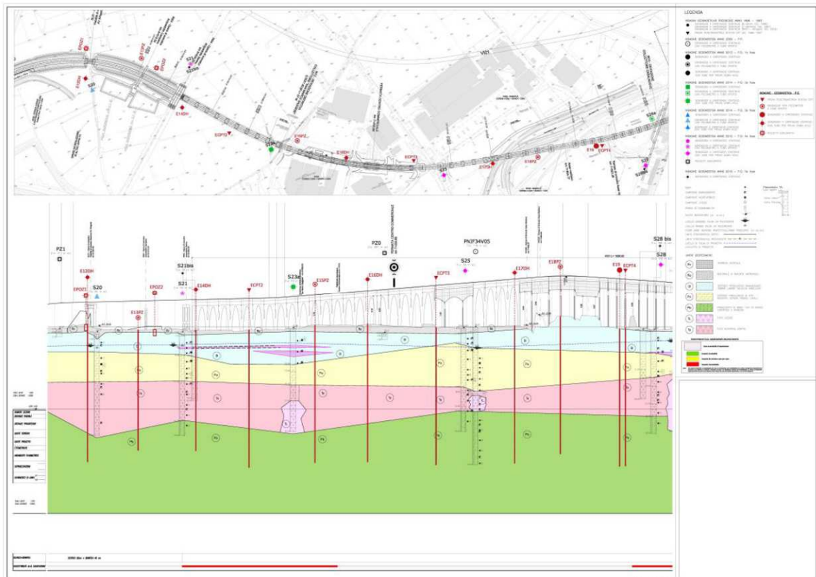
Figura 4 – Successione e andamento litostratigrafico delle formazioni geologiche presenti nell'area a vallo del campo pozzi", interessate dalla realizzazione delle pile del viadotto della TAV NA-BA
