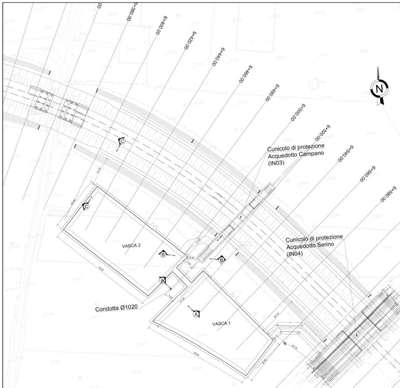
Figura 1 - planimetria delle vasche e delle opere di protezione delle condotte di adduzione idrica interferite (cunicoli e canali fuggatori)
