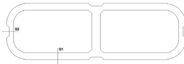
Figura 17: Sezioni di verifica dell'armatura orizzontale della pila
