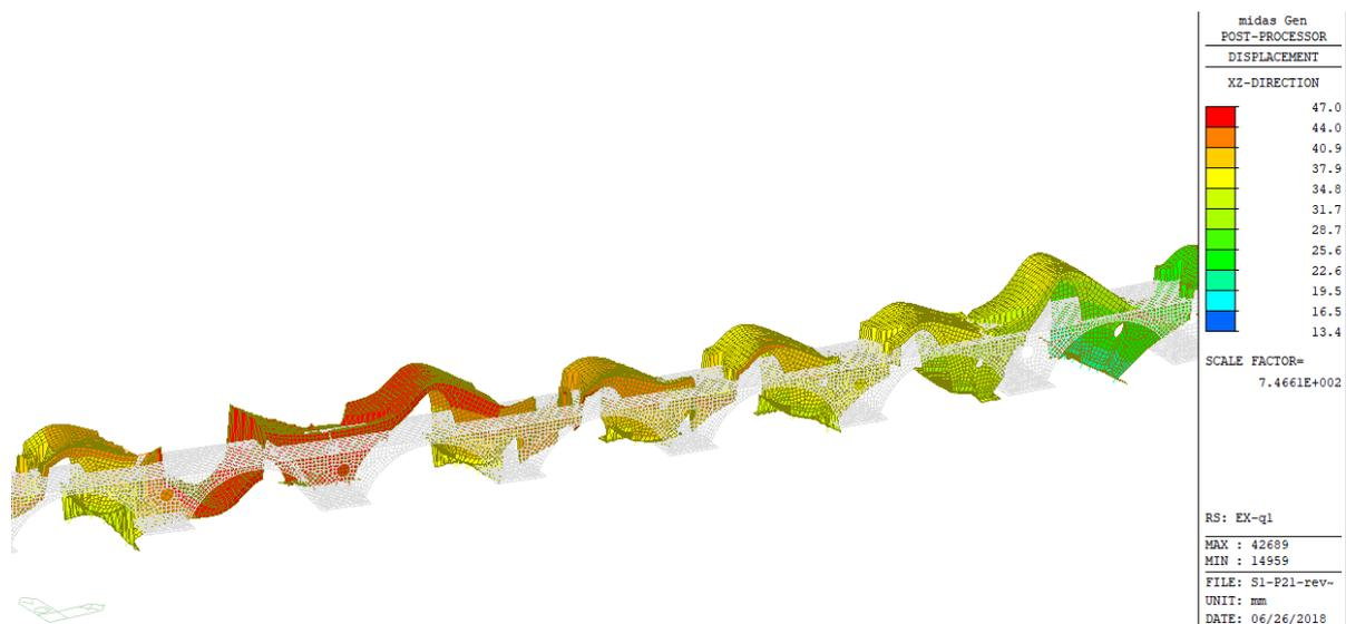
Spostamenti sisma longitudinale da P7 a P13 (q=1)
