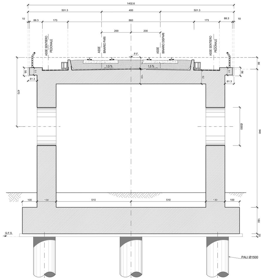
SEZIONE TIPO IN MEZZERIA-CAMPATA
