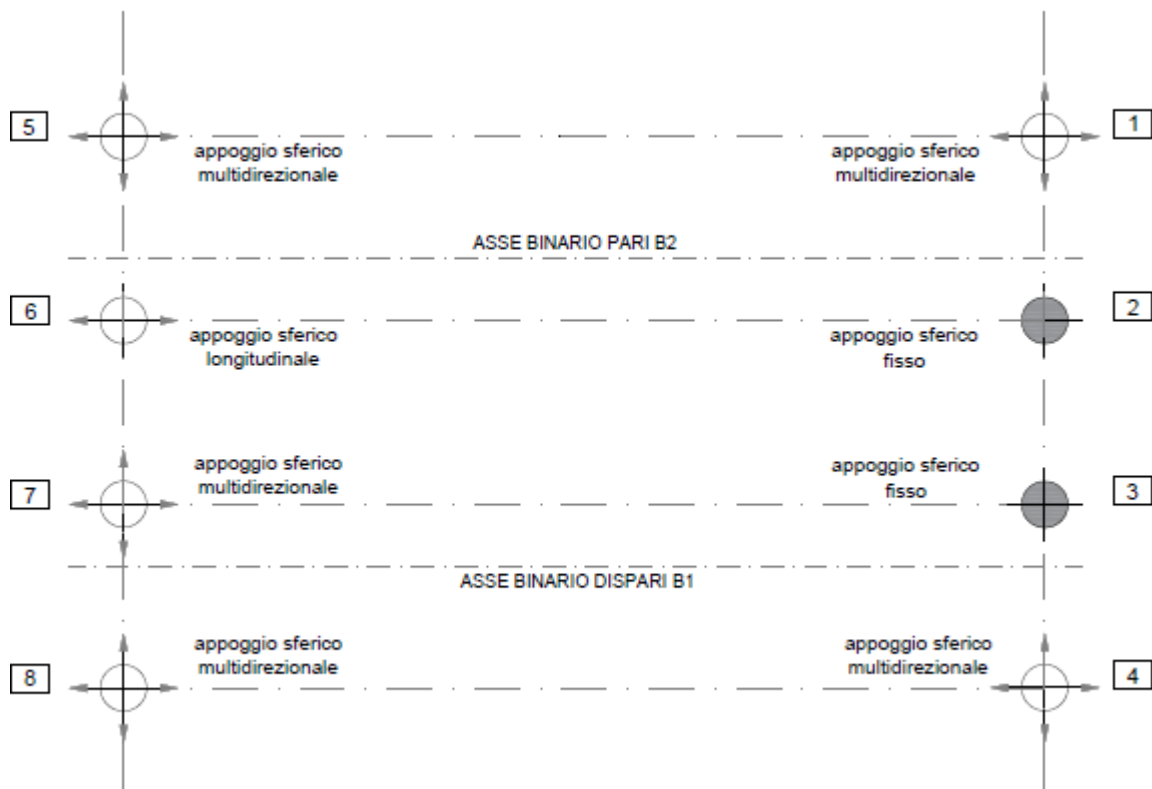
Figura 5: Schema di vincolo dell'impalcato tipo
