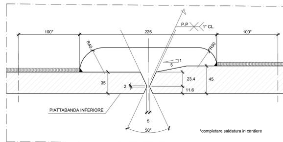
N.B.: SI RICORDA AI SENSI DELLA CIRCOLARE 44S LA NECESSITA' DI PREDISPORRE ADEGUATI TALLONI DI SALDATURA
