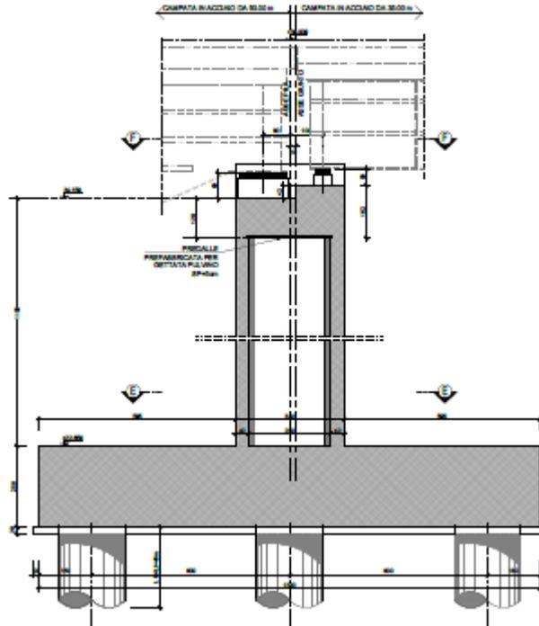
Figura 3: Sezione in direzione longitudinale rispetto all'asse del viadotto
