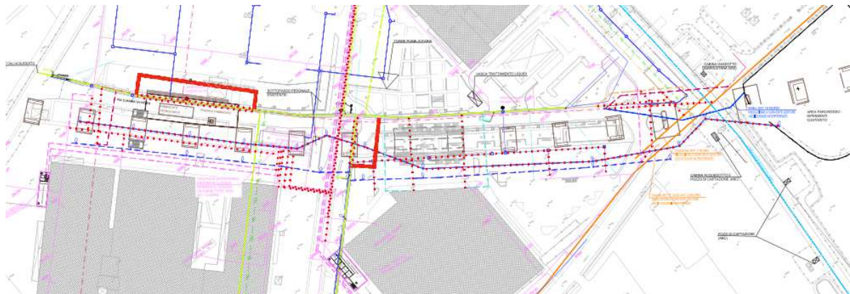
Stralcio elaborato di progetto con codifica IF1M.0.0.E.ZZ.AZ.VI.01.0.0.0011.A – interferenze sottoservizi Centro Commerciale
