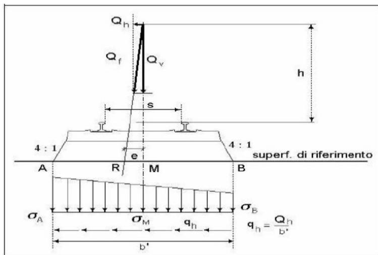
Considerando uno spessore medio di ballast al di sotto delle traverse di 43.3cm si ottiene:
