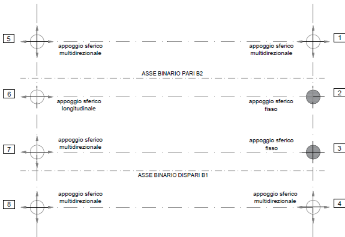
Figura 53: Schema dei vincoli di appoggio dell'impalcato
