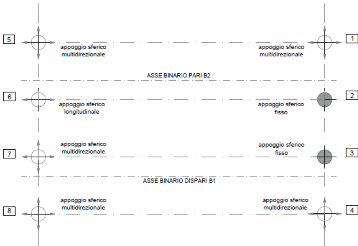
Figura 5: Schema di vincolo dell'impalcato tipo
