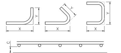
Le lunghezze totali "L = ..." riportate in distinta, sono state calcolate sulla base delle dimensioni esterne X+Y (metodo A di ISO3766).
