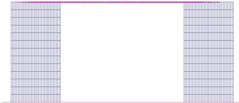
Figura 20 - Carichi avviamento/frenatura applicati alla copertura (Vista prospettica)
