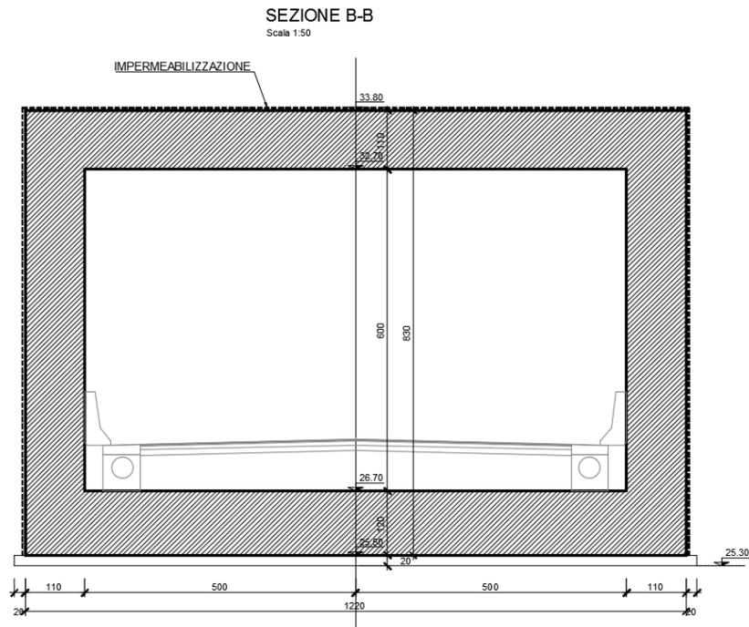
**Figura 6-Sottopasso - Sezione B-B**
