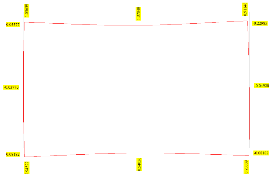
Figura 37 – Deformata con valore degli spostamenti – SLE
