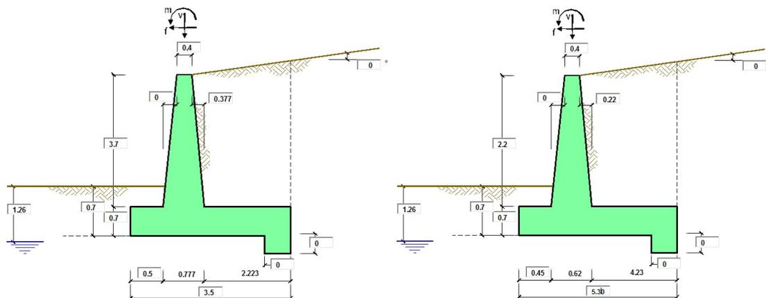
Figura 9-Schematizzazione muro
