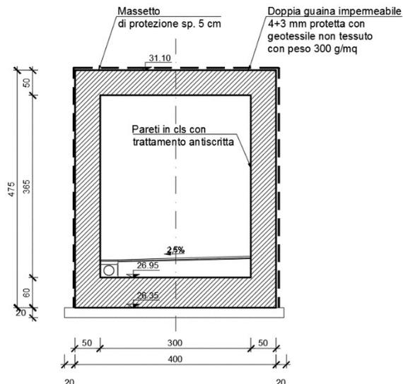
**Figura 7-Sottopasso -Sezione Trasversale**
