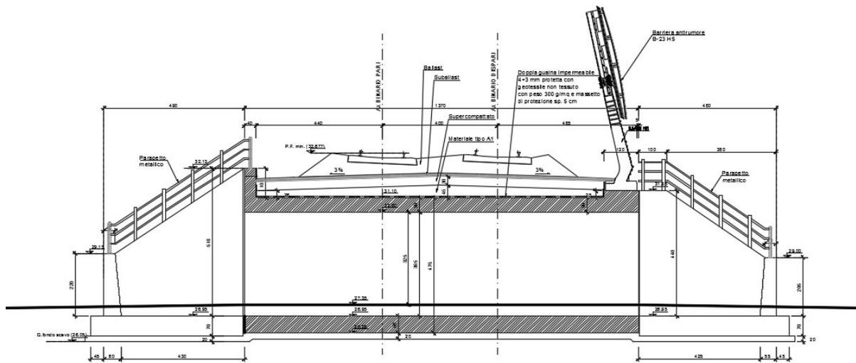
**Figura 6-Sottopasso - Sezione Longitudinale**
