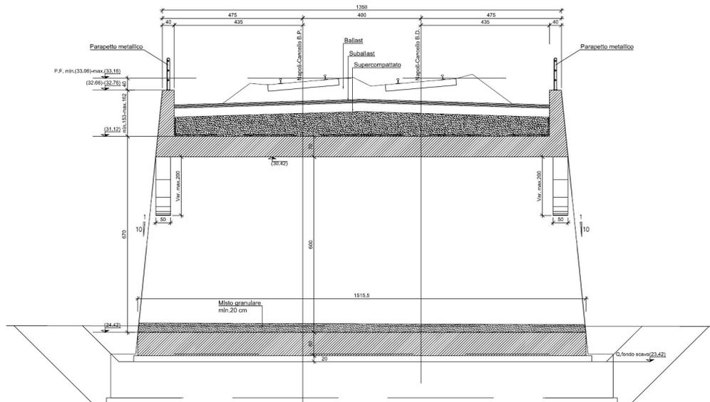
**Figura 4-Sottopasso - Sezione Longitudinale**
