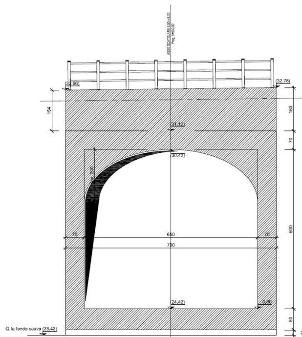
**Figura 5-Sottopasso -Sezione Trasversale**
