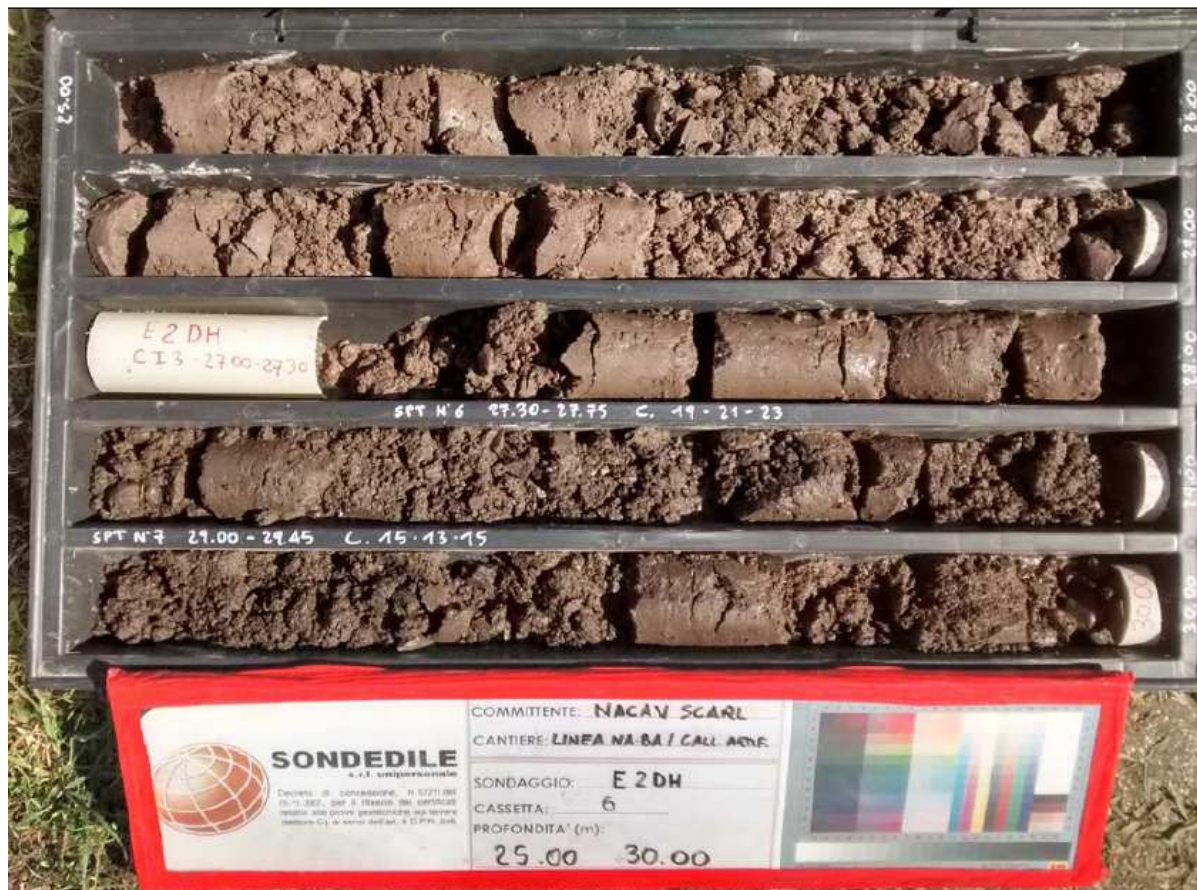
Figura 18 – Esempio dell'unità litologica PO da sondaggio (E2DH – da 25 a 30 m di profondità)
