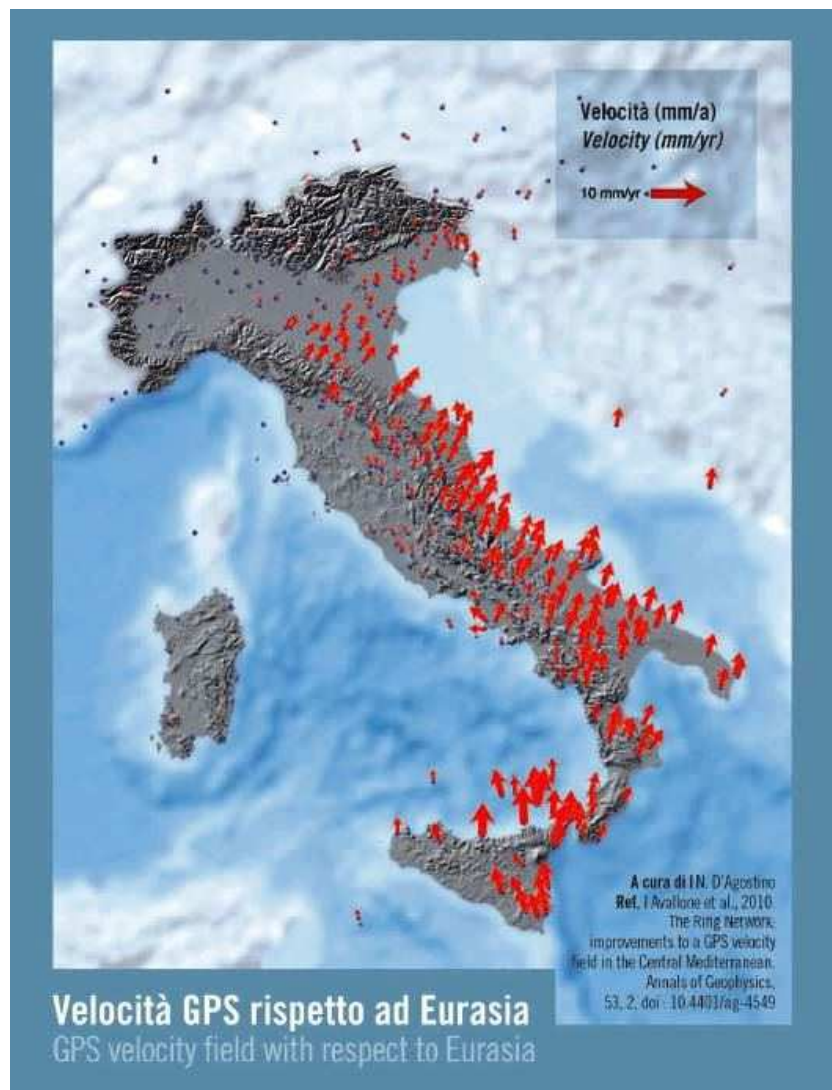
Figura 47 - Mappa, pubblicata dall'INGV, ottenuta dai dati GPS, rappresenta la velocità alla quale si muove l'Italia, oggi, rispetto all'Europa stabile. Il nostro paese, a causa delle forti spinte delle placche tettoniche, si deforma e i massimi valori di deformazione coincidono con le aree sismiche del nostro paese
