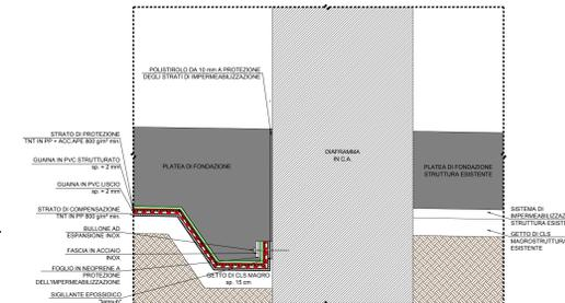
PARTICOLARE 6 - COLLEGAMENTO SISTEMA DI IMPERMEABILIZZAZIONE MULTISTRATO CON SISTEMA DI IMPERMEABILIZZAZIONE ESISTENTE
