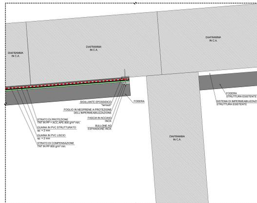
PARTICOLARE 7 - SEZIONE LONGITUDINALE TIPOLOGICA SU IMPERMEABILIZZAZIONE
