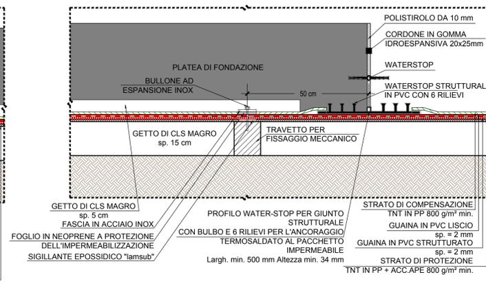
**PARTICOLARE 4 - SEZIONE LONGITUDINALE TIPOLOGICO DIAFRAMMA TRASVERSALE**
