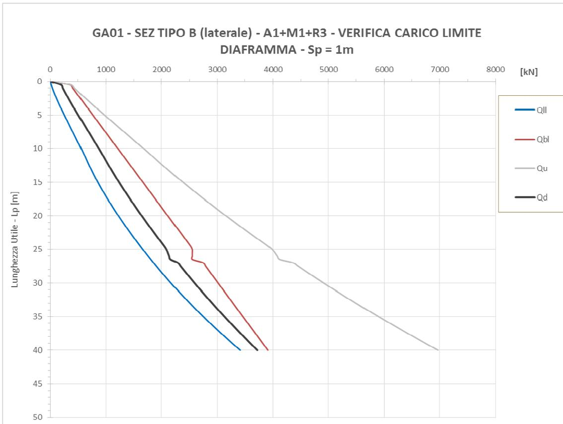
Figura 112. Curva di capacità portante diaframma laterale sezione B
