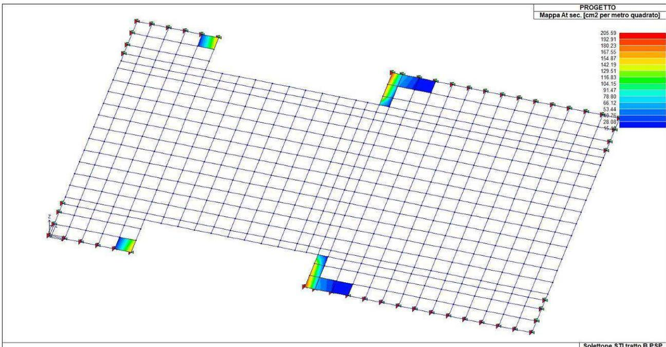
*Armatura a taglio lungo la direzione secondaria (per le zone non colorate l'armatura è sufficiente).*
