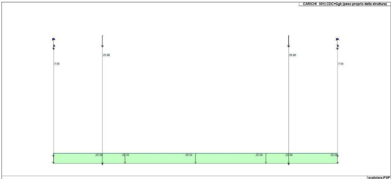
Figura 67. Caso di carico CDC 1 (Peso proprio della struttura)
