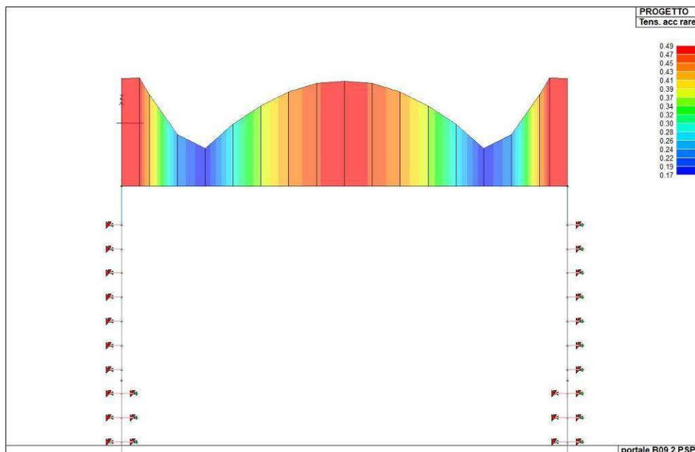
Figura 106. *Indice di verifica della tensione dell'acciaio per combinazioni rare*
