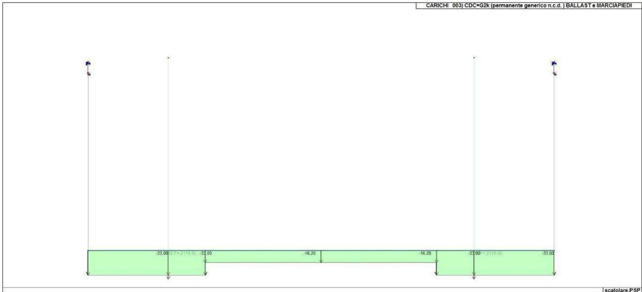
Figura 69. Caso di carico CDC 3 (Permanente ballast e marciapiedi)
