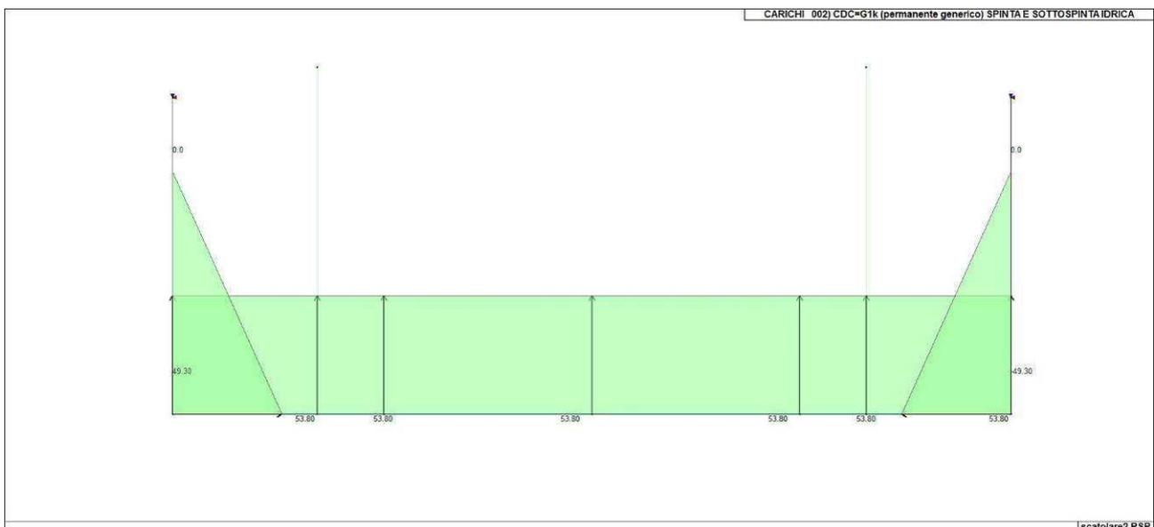
Figura 68. Caso di carico CDC 2 (Permanente spinta e sottospinta)
