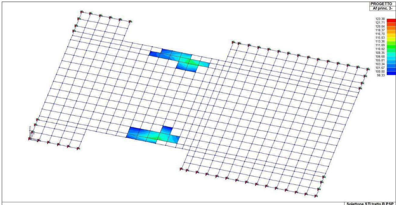
*Armatura longitudinale inferiore (per le zone non colorate l'armatura è sufficiente).*
