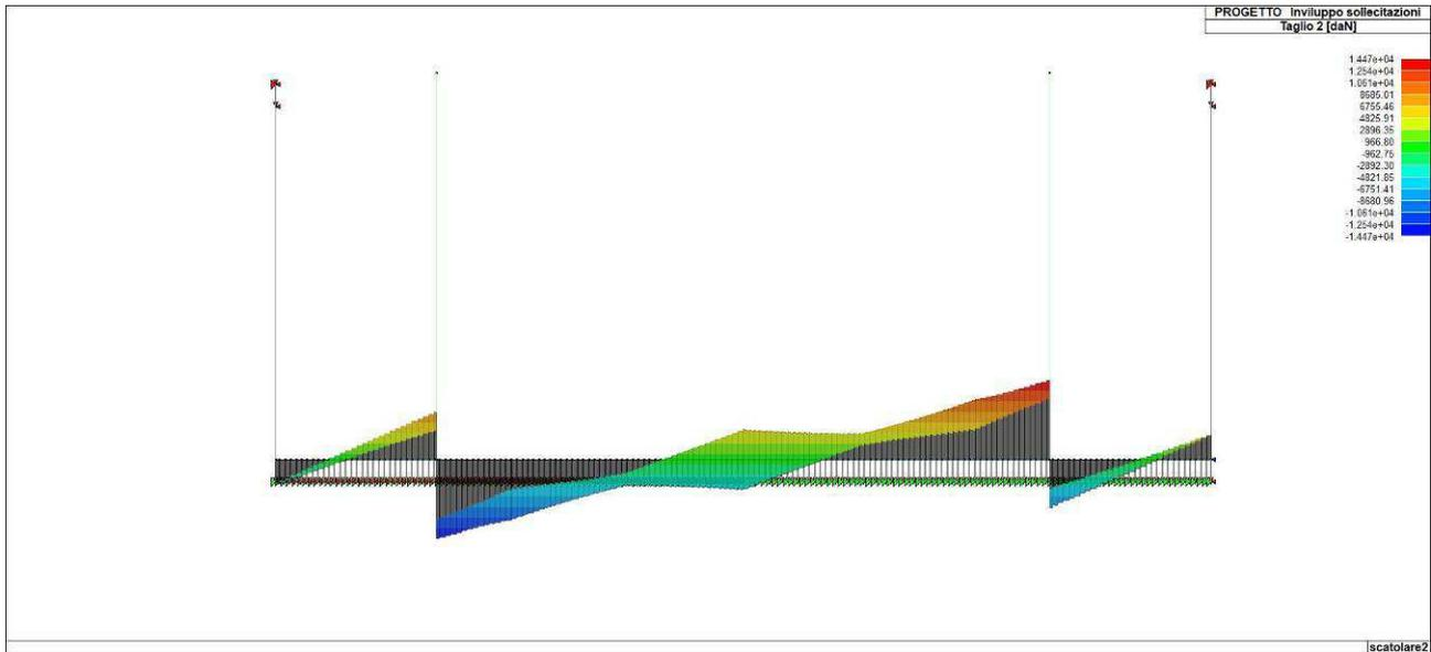
Figura 90. Inviluppo del taglio del solettone di fondazione
