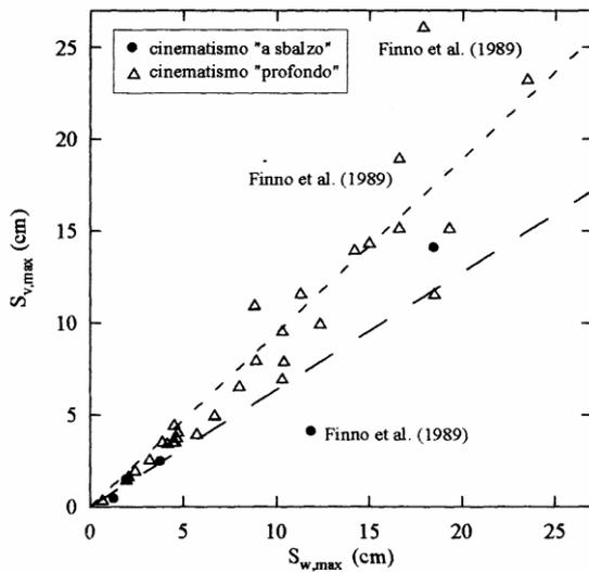
Figura 114. Correlazione tra cedimento massimo del piano campagna e spostamento max della parete (Pane e Tamagnini, 1997 dopo Mana & Clough, 1981)
