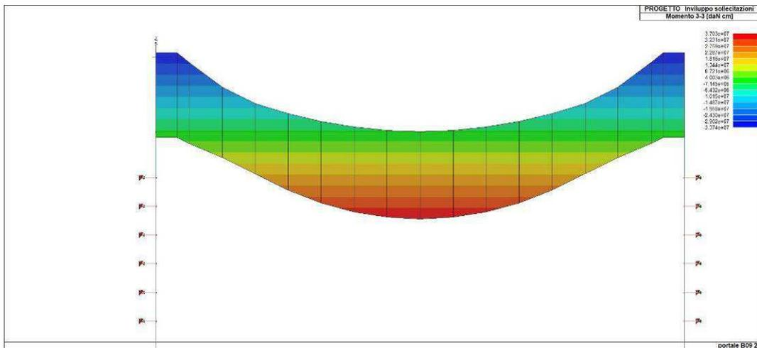
Figura 51. *Inviluppo del momento flettente del solettone di copertura*
