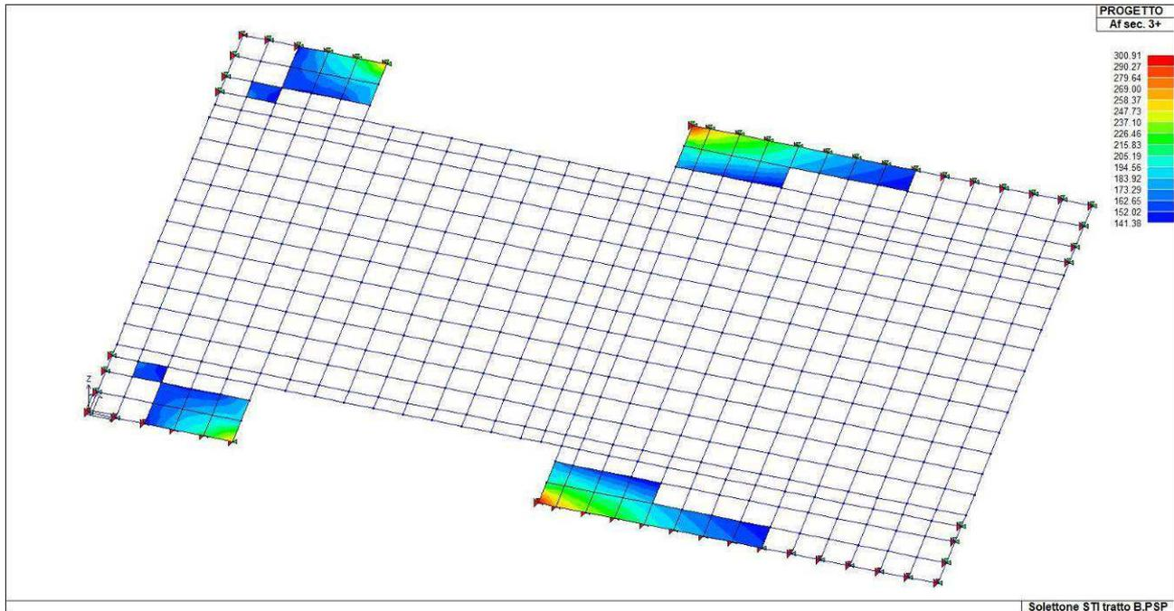
*Armatura trasversale superiore (per le zone non colorate l'armatura e sufficiente).*
