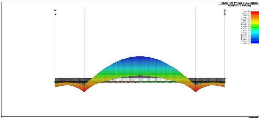
Figura 79. Inviluppo del momento flettente del solettone di fondazione
