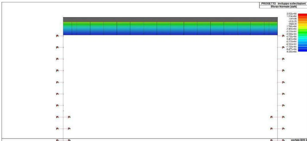
Figura 49. Involuppo dello sforzo normale del solettone di copertura
