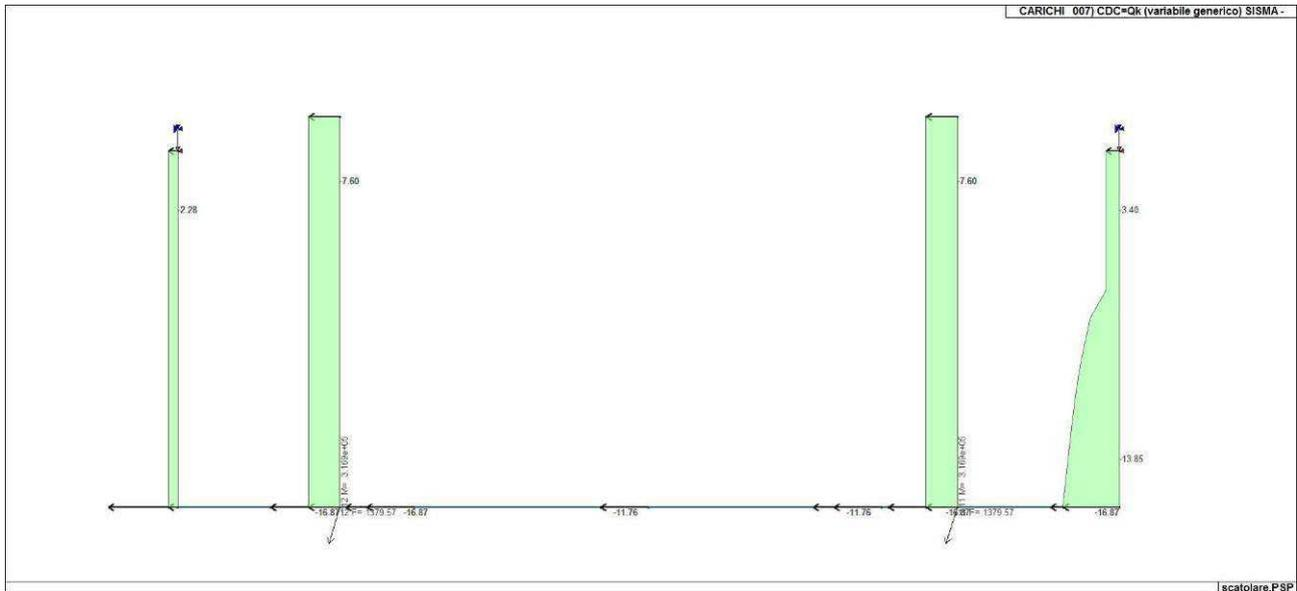
Figura 73. Caso di carico CDC 7 (Sisma X-)
