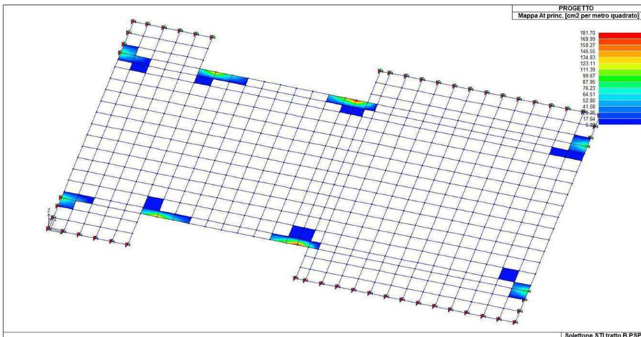
Armatura a taglio lungo la direzione principale (per le zone non colorate l'armatura e sufficiente).
