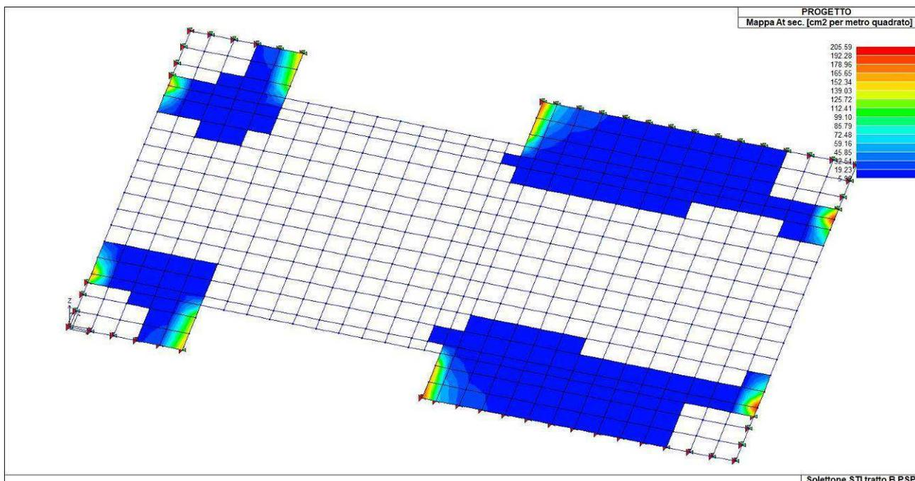
Armatura a taglio lungo la direzione secondaria (per le zone non colorate l'armatura e sufficiente).
