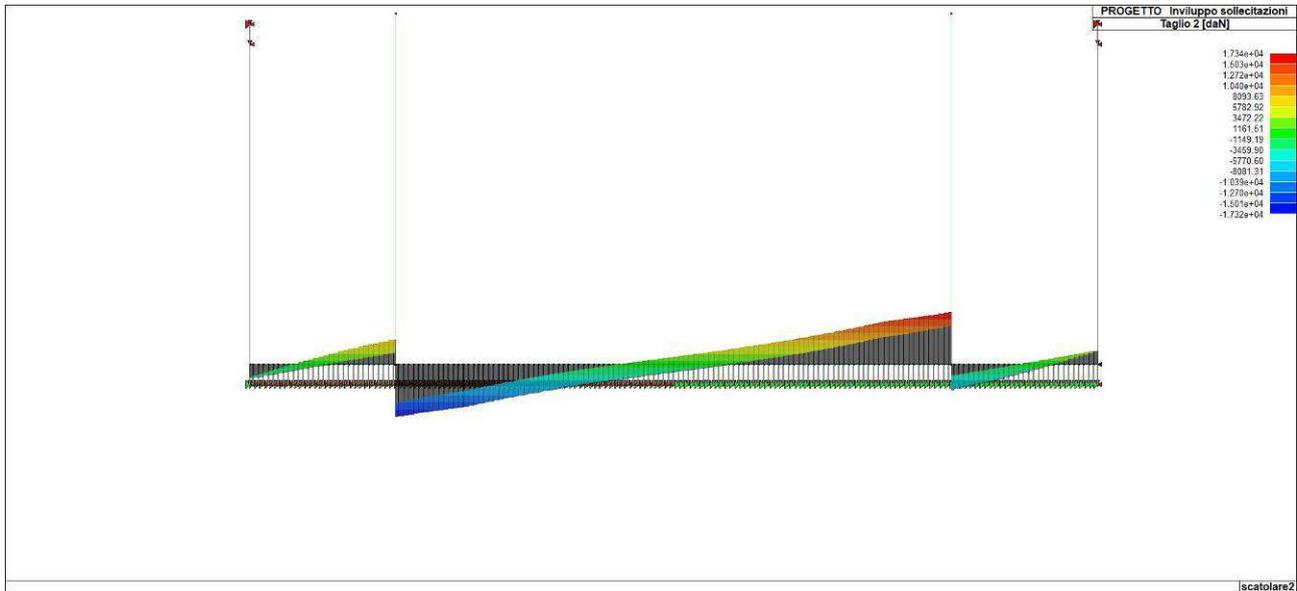
Figura 84. Involuppo del taglio del solettone di fondazione
