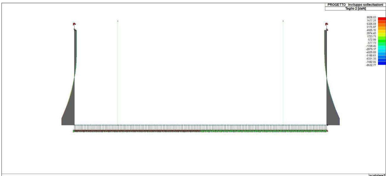
Figura 87. Involuppo del taglio delle fodere
