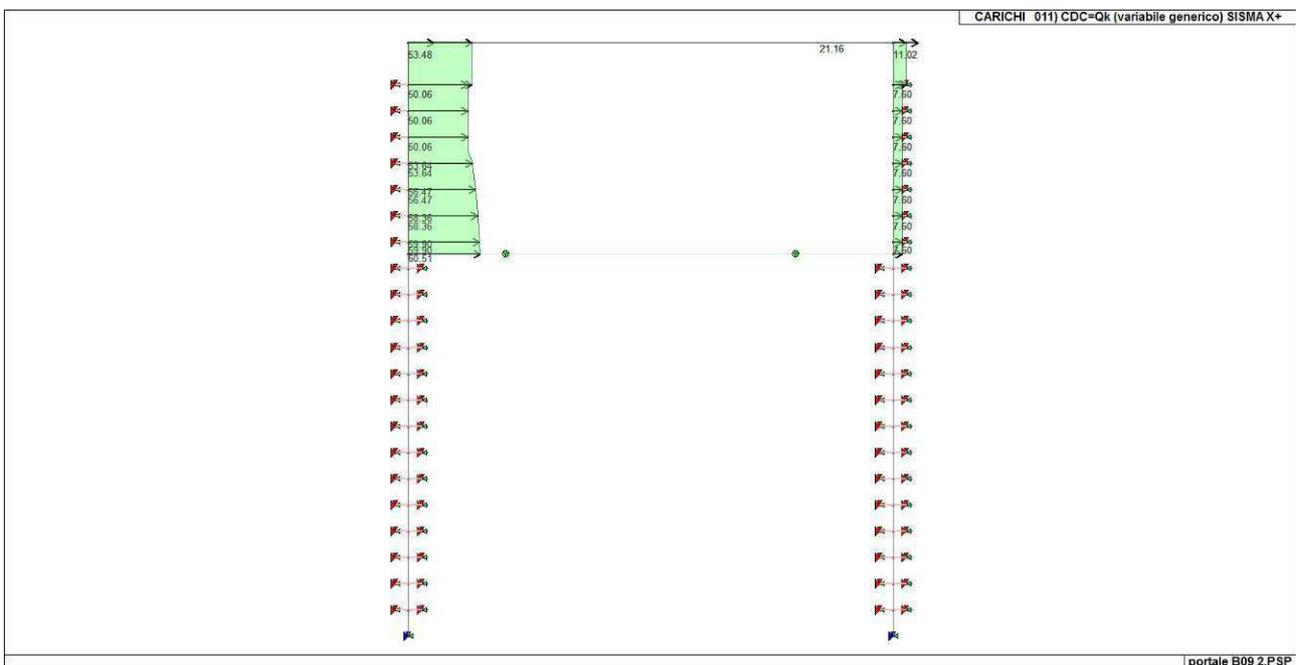
Figura 27. Caso di carico CDC 11 (Sisma X+)
