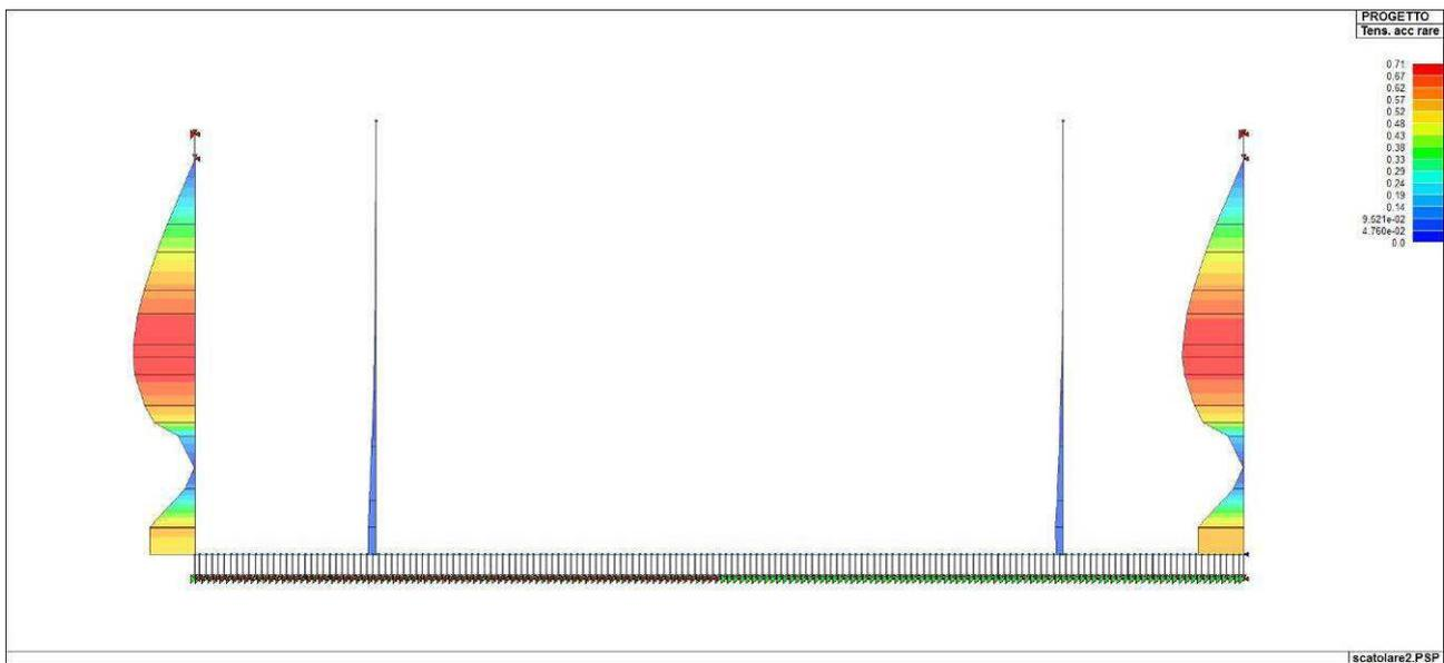
Figura 108. *Indice di verifica della tensione dell'acciaio per combinazioni rare*
