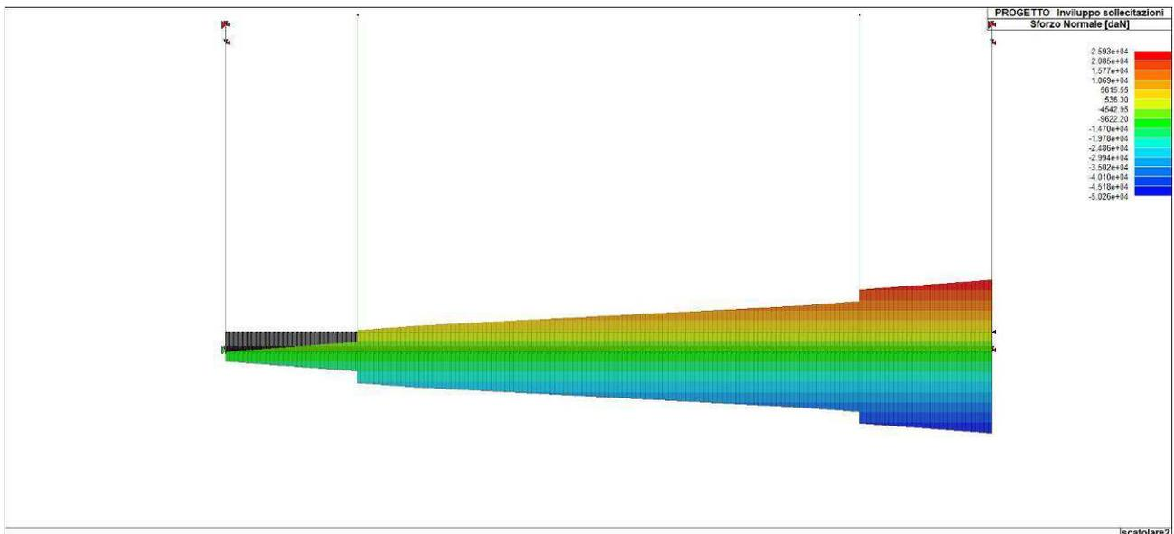
Figura 83. Inviluppo dello sforzo normale del solettone di fondazione
