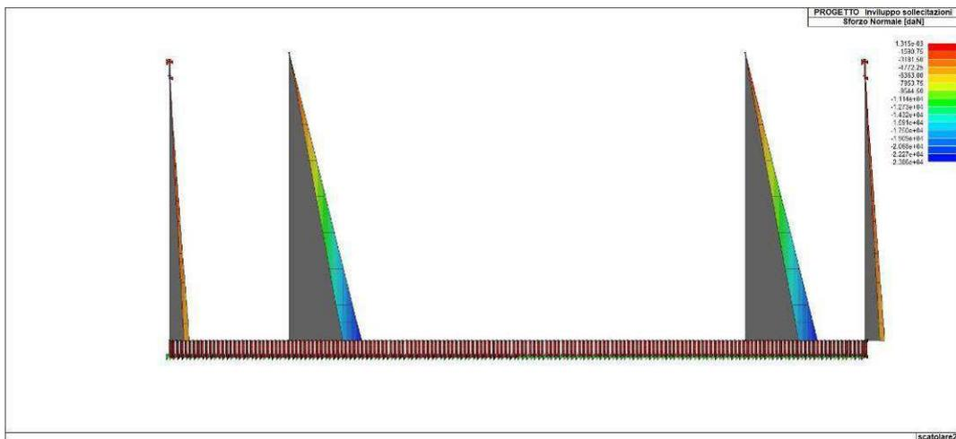
Figura 74. Inviluppo dello sforzo normale delle fodere
