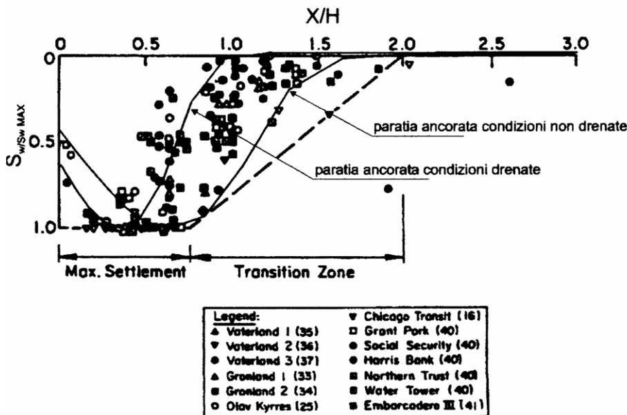
Figura 116. *Profili di subsidenza normalizzati (Pane & Tamagnini, 1997 Mana & Clough, 1981)*
