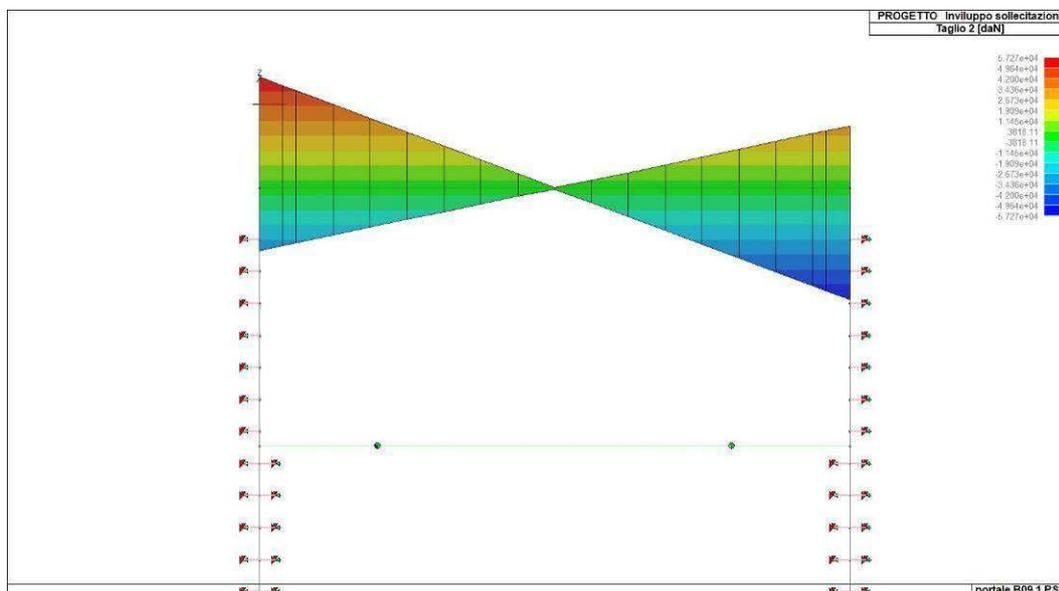
Figura 36. Involuppo del taglio del solettone di copertura
