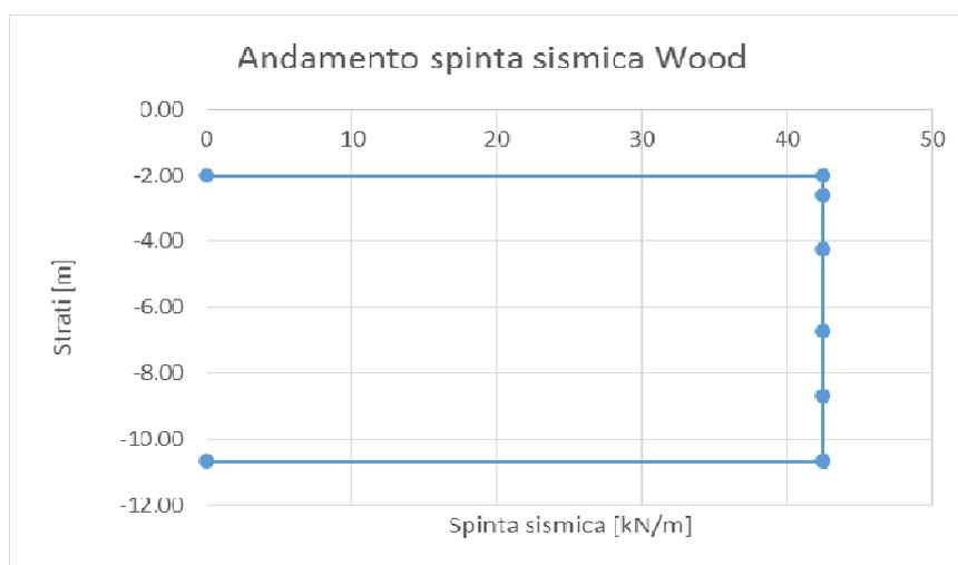
Figura 64. Diagramma andamento spinta Wood
