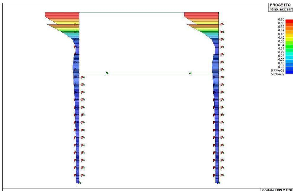
Figura 104. *Indice di verifica della tensione dell'acciaio per combinazioni rare*
