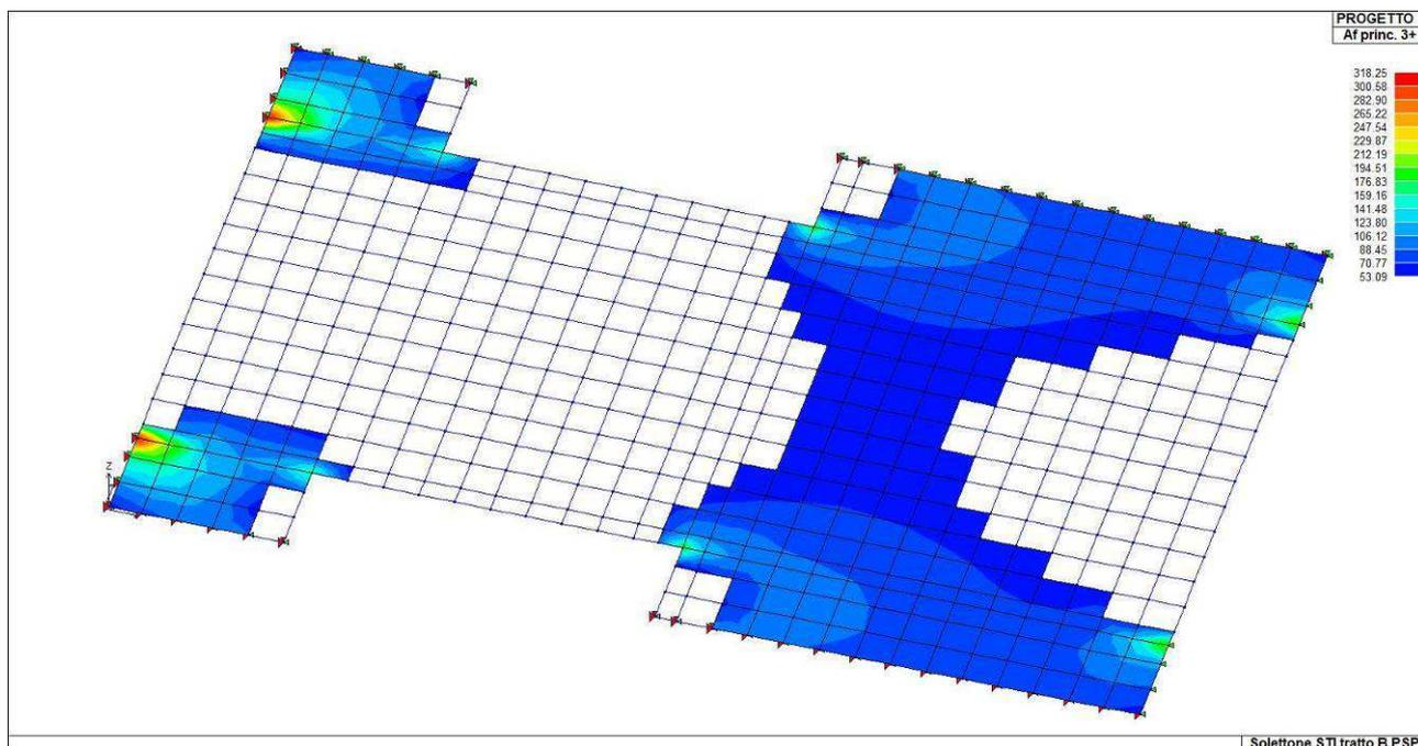
*Armatura longitudinale superiore (per le zone non colorate l'armatura e sufficiente).*
