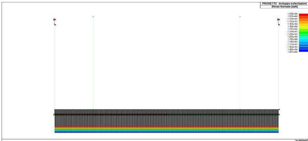
Figura 77. *Inviluppo dello sforzo normale del solettone di fondazione*
