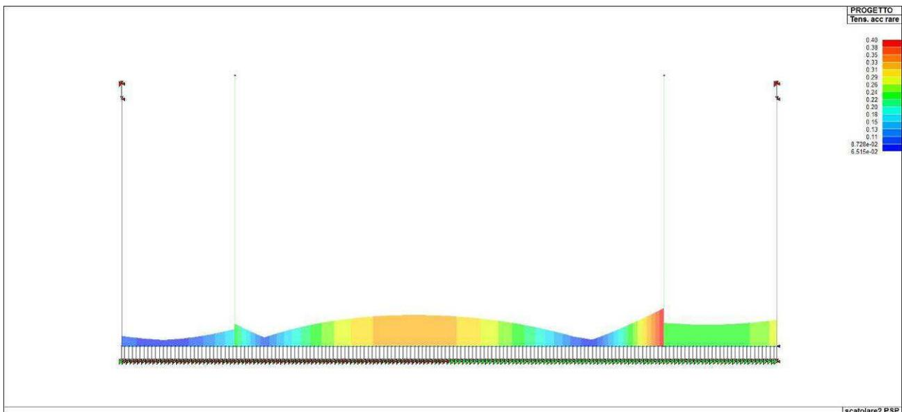
Figura 110. *Indice di verifica della tensione dell'acciaio per combinazioni rare*
