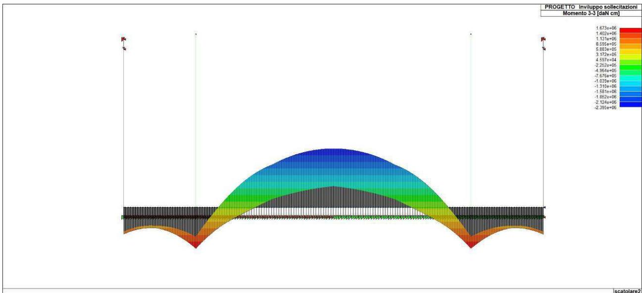
Figura 91. Inviluppo del momento flettente del solettone di fondazione
