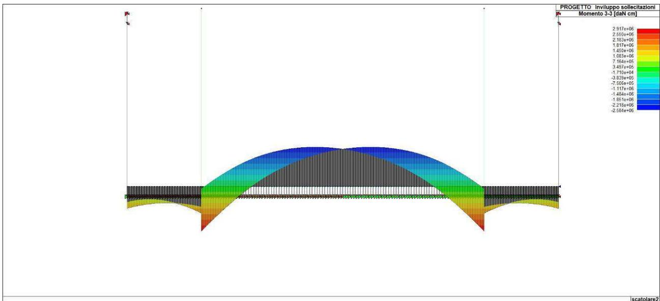
Figura 85. Involuppo del momento flettente del solettone di fondazione
