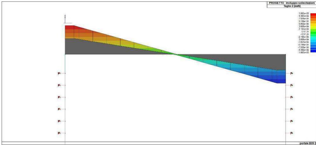
Figura 50. *Inviluppo del taglio del solettone di copertura*
