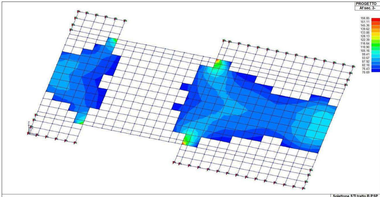
*Armatura trasversale inferiore (per le zone non colorate l'armatura è sufficiente).*
