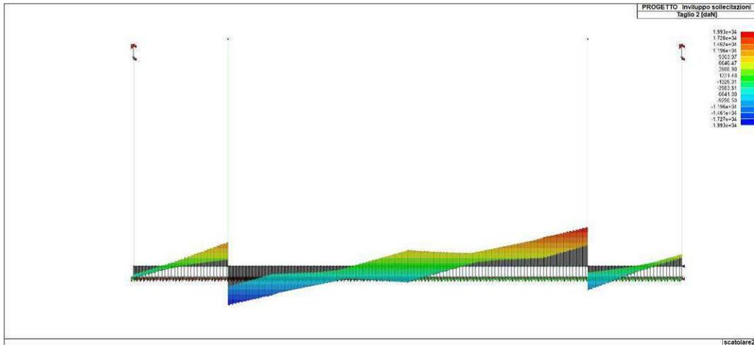
Figura 78. Inviluppo del taglio del solettone di fondazione
