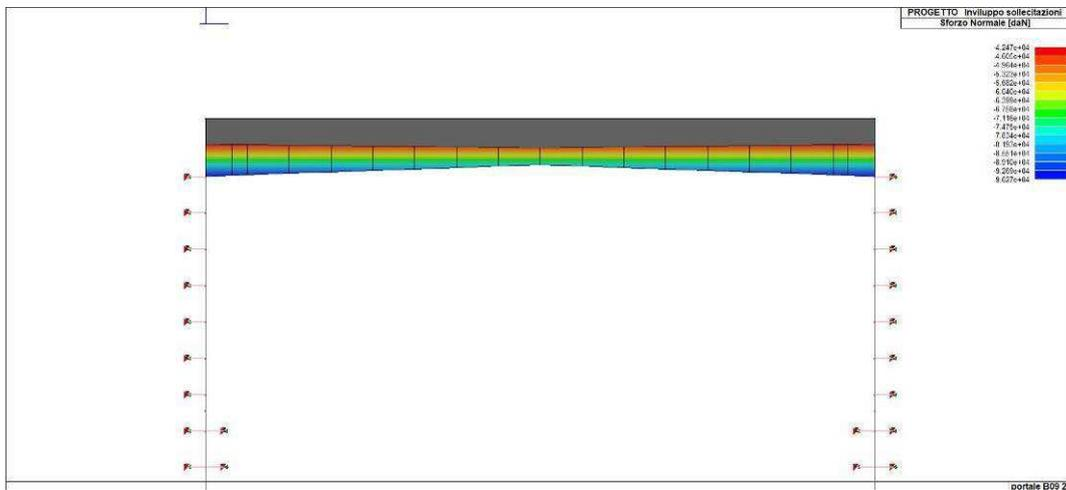
Figura 55. Involuppo dello sforzo normale del solettone di copertura
