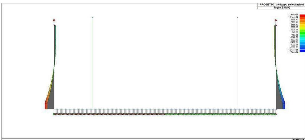
Figura 75. Inviluppo del taglio delle fodere
