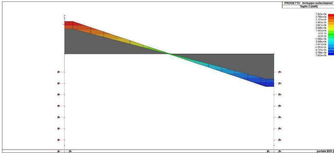
Figura 62. *Inviluppo del taglio del solettone di copertura*
