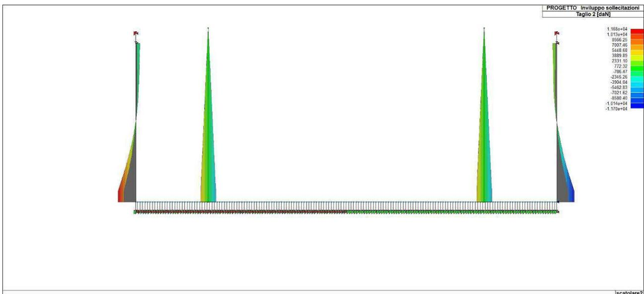
Figura 81. *Involuppo del taglio delle fodere*
