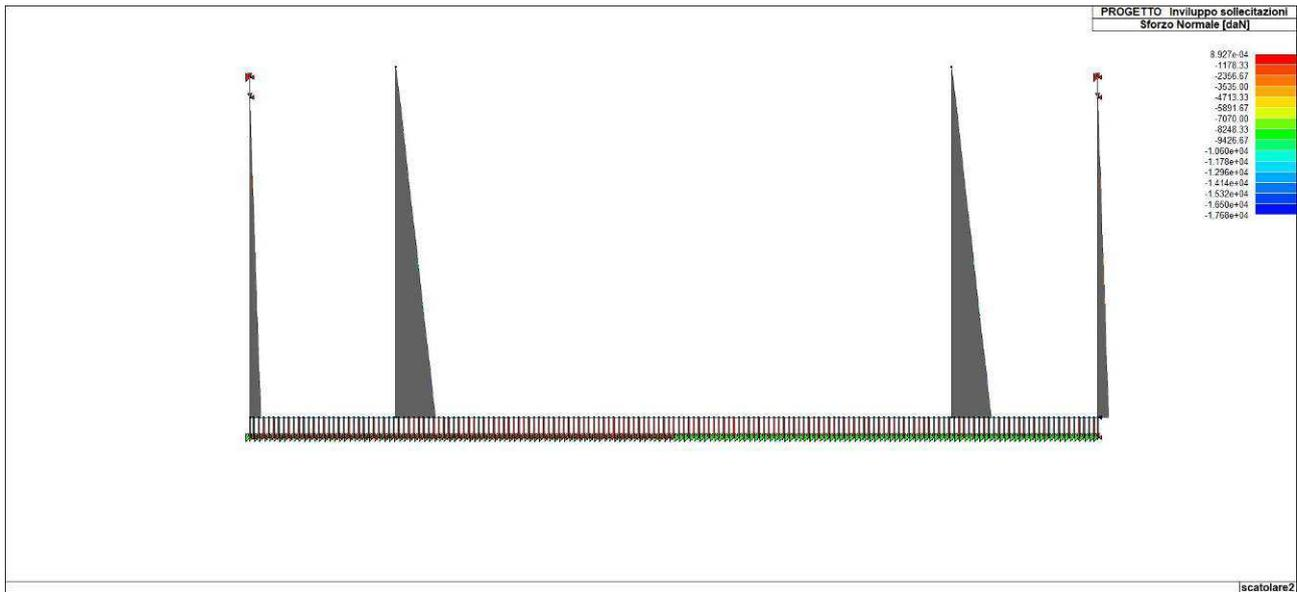
Figura 86. Involuppo dello sforzo normale delle fodere
