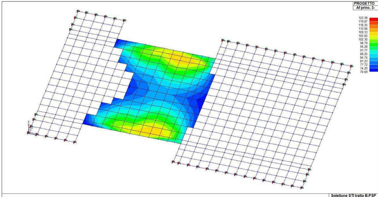
*Armatura longitudinale inferiore (per le zone non colorate l'armatura e sufficiente).*
