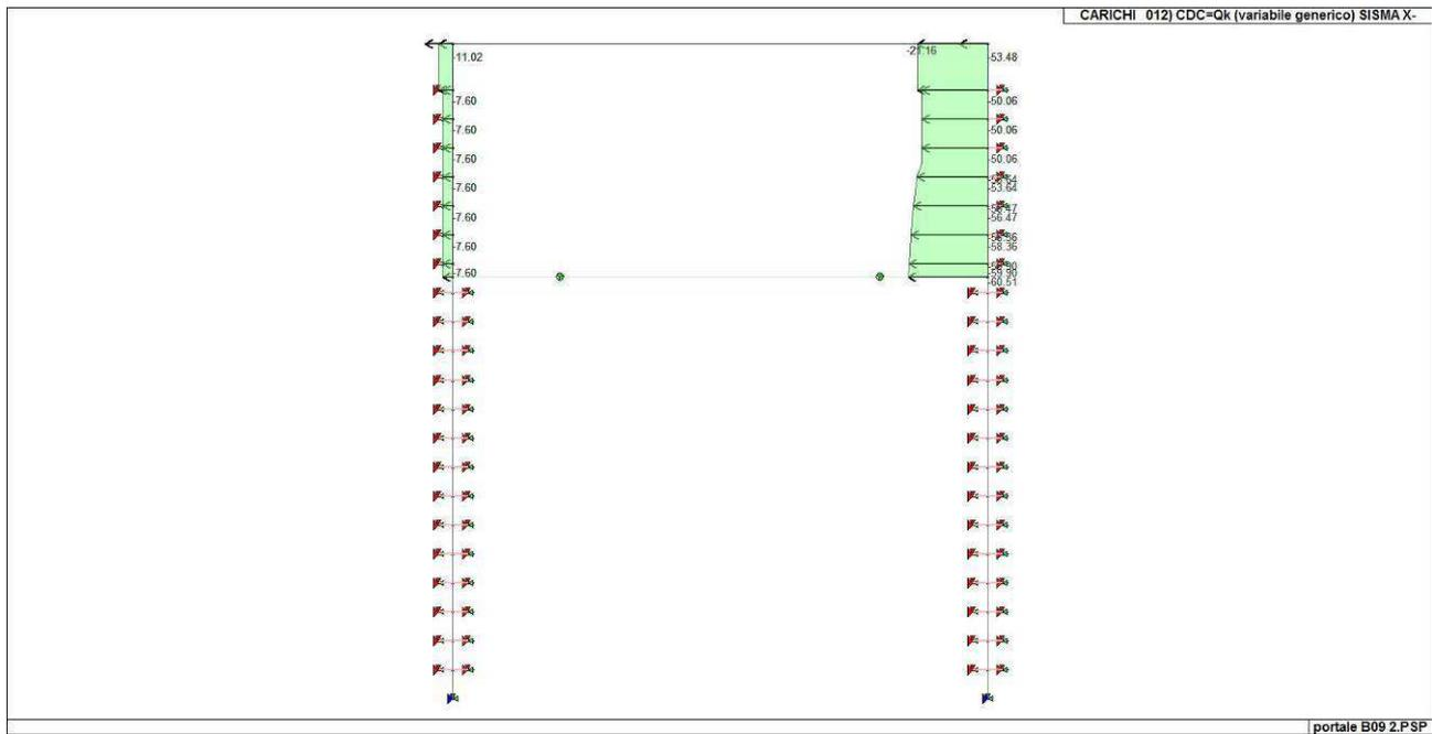
Figura 28. Caso di carico CDC 12 (Sisma X-)
