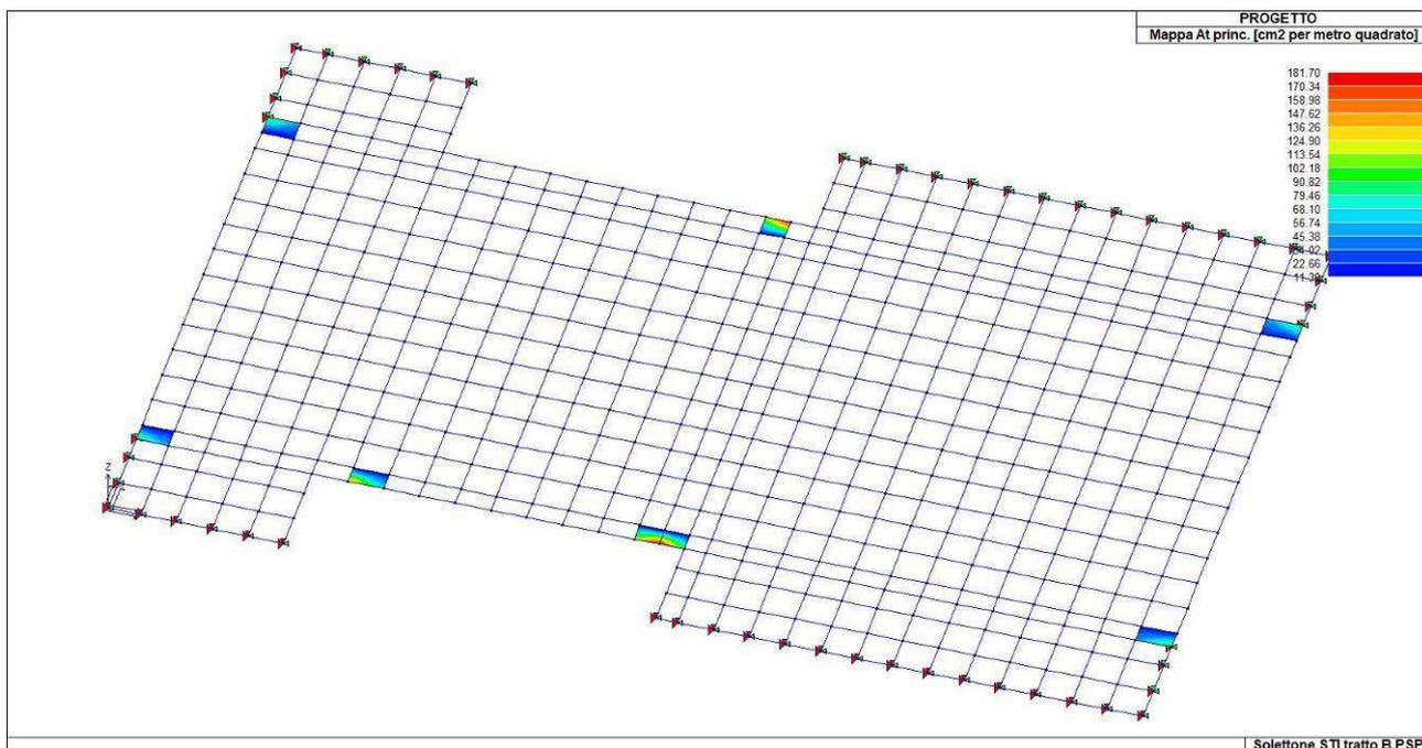
*Armatura a taglio lungo la direzione principale (per le zone non colorate l'armatura è sufficiente).*
