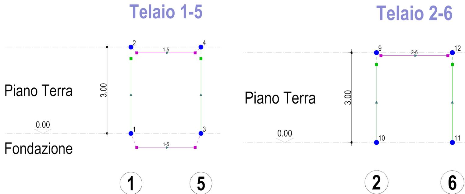
Figura 12: Numerazione dei nodi e delle aste del modello di analisi – Telai trasversali 1-2
