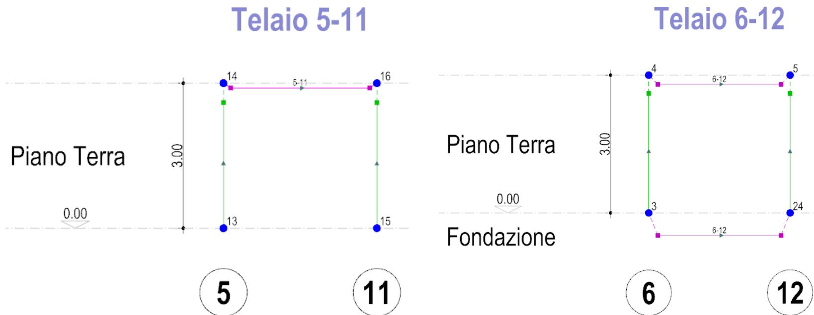
Figura 14: Numerazione dei nodi e delle aste del modello di analisi – Telaio trasversale 5
