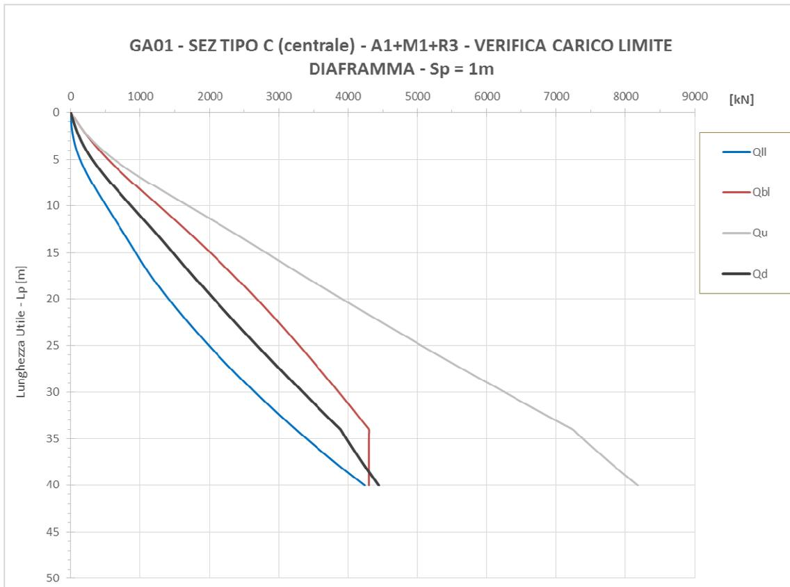
Figura 123. Curva di capacità portante diaframma centrale sezione C1
