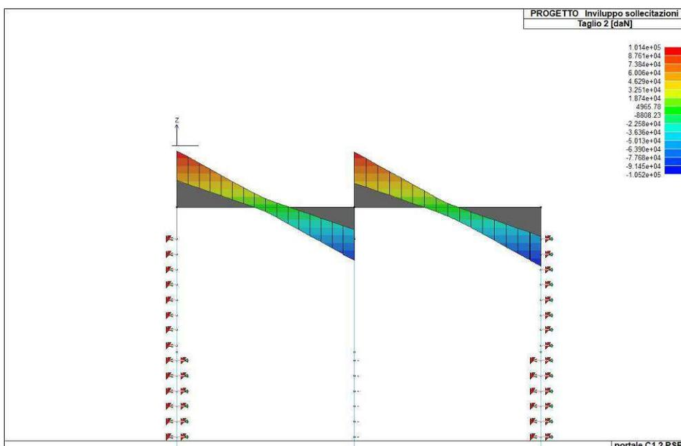
Figura 52. Involuppo del taglio del solettone di copertura
