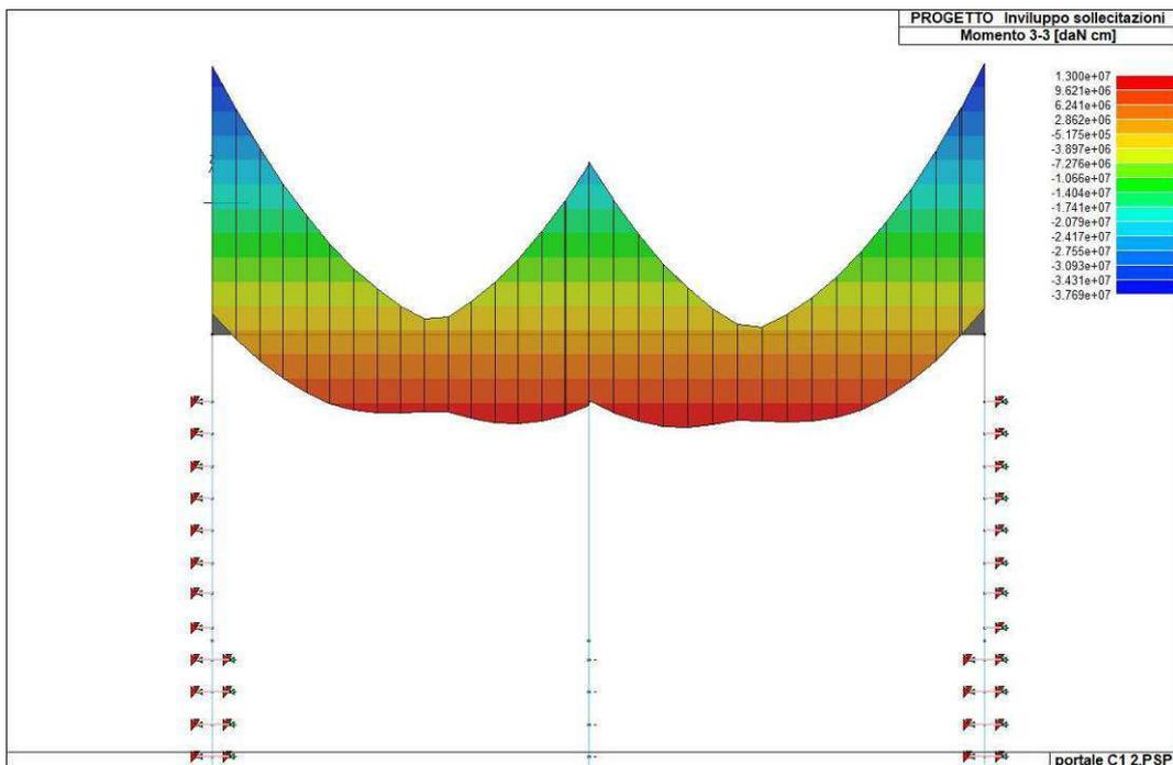
Figura 59. Inviluppo del momento flettente del solettone di copertura
