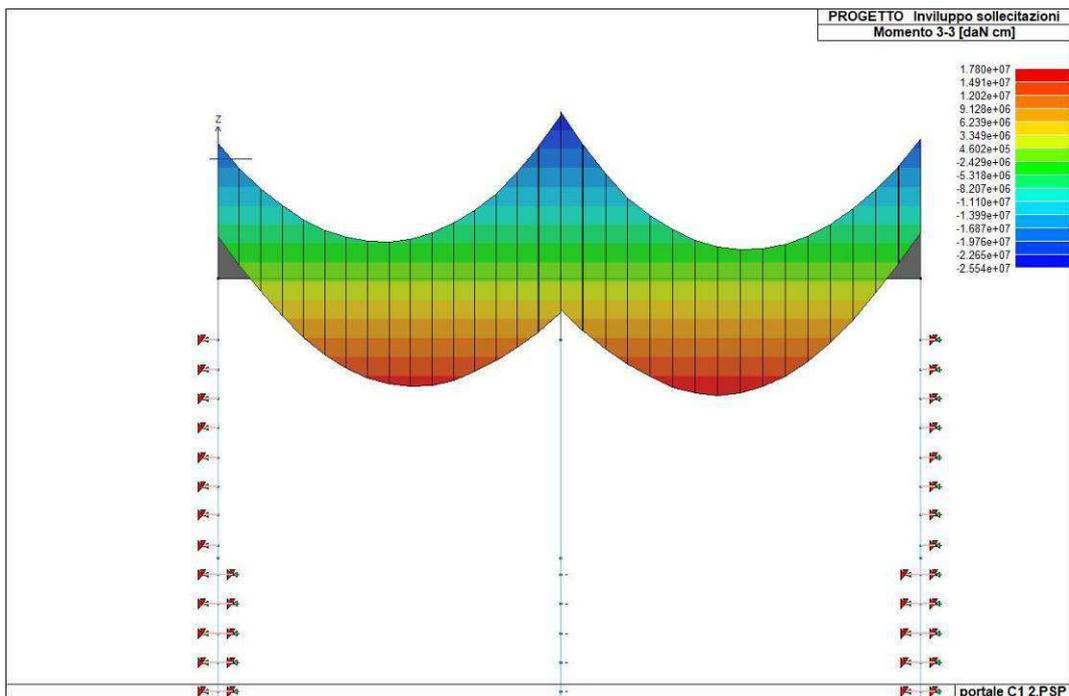
Figura 65. Inviluppo del momento flettente del solettone di copertura
