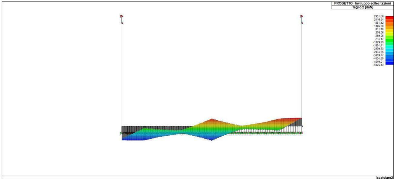
Figura 92. Inviluppo del taglio del solettone di fondazione
