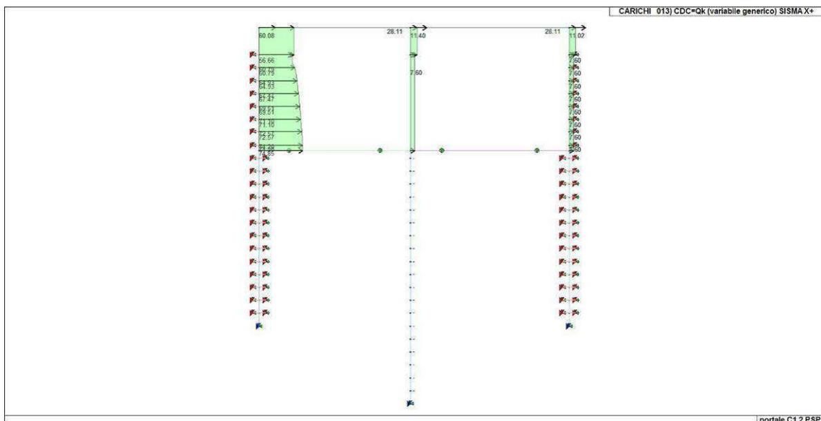
Figura 29. Caso di carico CDC 13 (Sisma X+)
