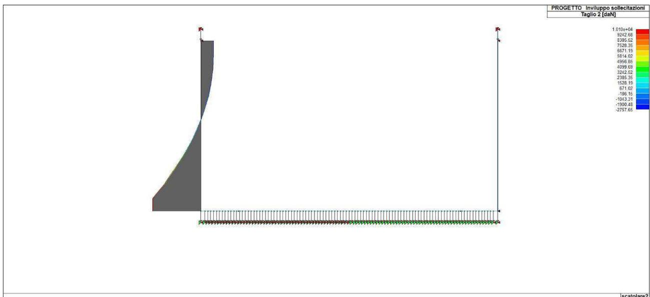
Figura 89. Involuppo del taglio delle fodere
