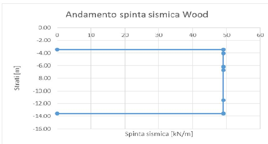
Figura 66. *Diagramma andamento spinta Wood*
