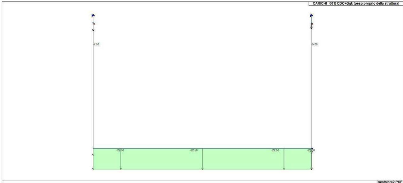
Figura 69. Caso di carico CDC 1 (Peso proprio della struttura)
