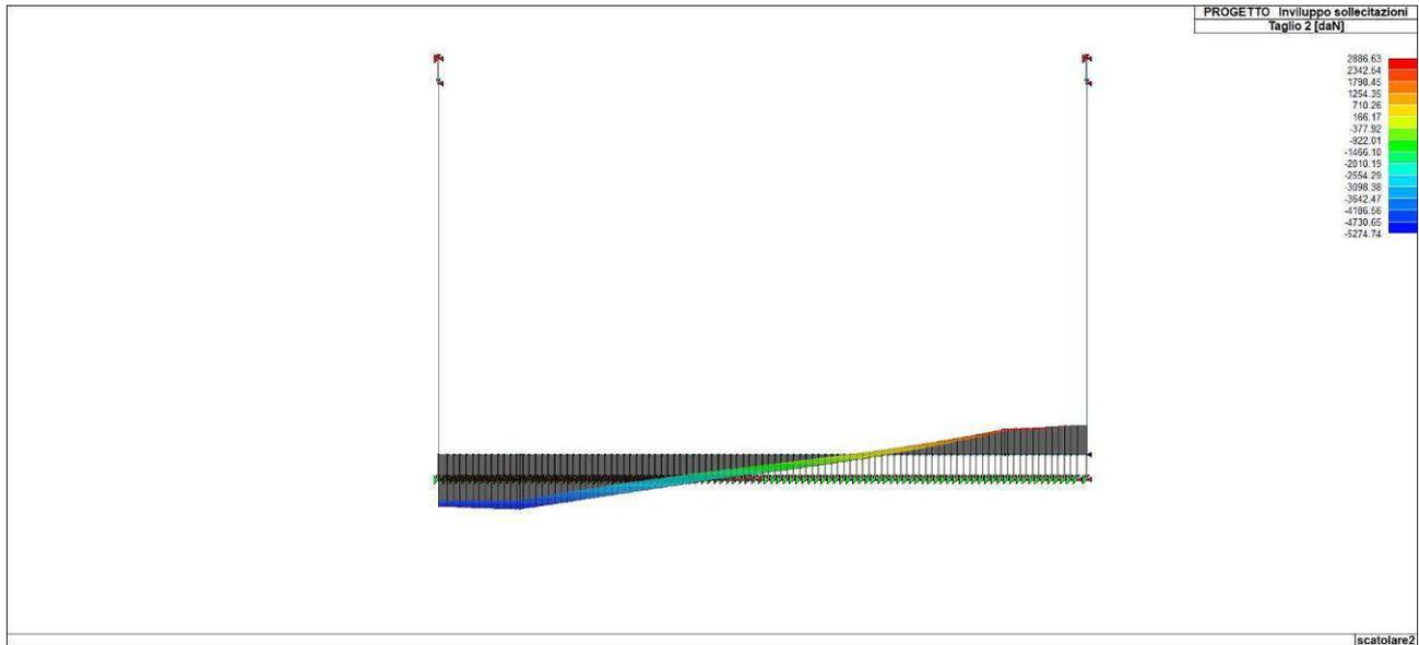
Figura 86. Involuppo del taglio del solettone di fondazione
