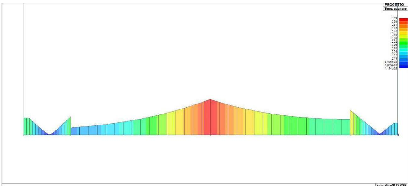
Figura 119. *Indice di verifica della tensione dell'acciaio per combinazioni rare*
