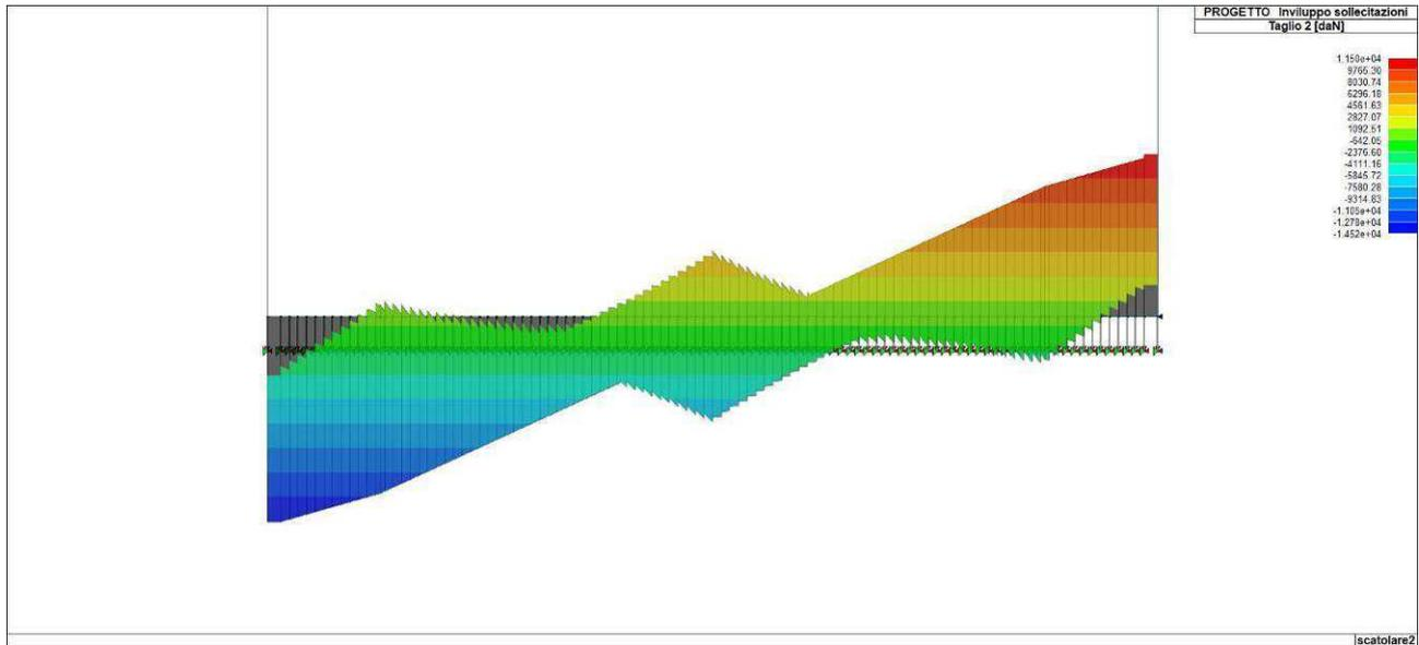
Figura 80. *Inviluppo del taglio del solettone di fondazione*
