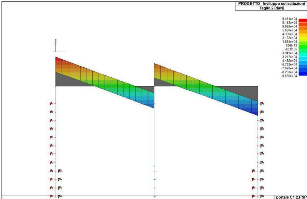
Figura 58. Inviluppo del taglio del solettone di copertura
