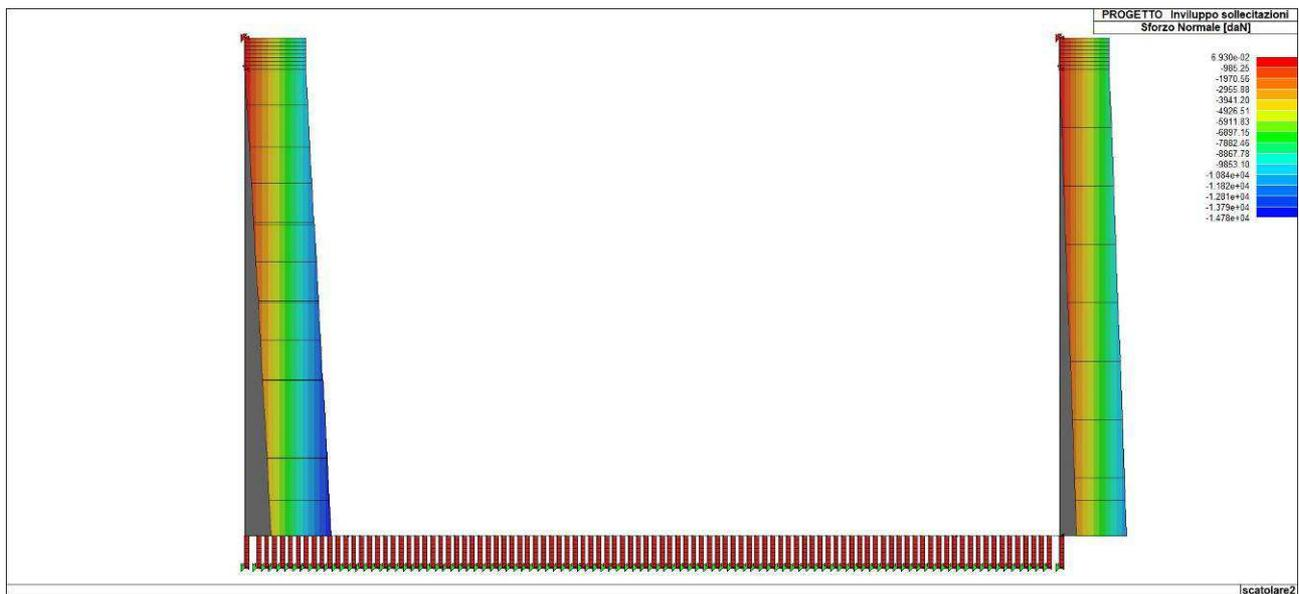
Figura 76. Inviluppo dello sforzo normale delle fodere
