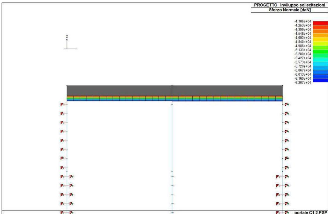
Figura 63. *Involuppo dello sforzo normale del solettone di copertura*
