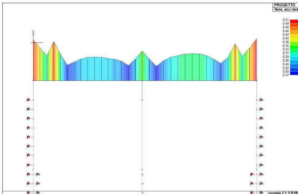
Figura 115. *Indice di verifica della tensione dell'acciaio per combinazioni rare*
