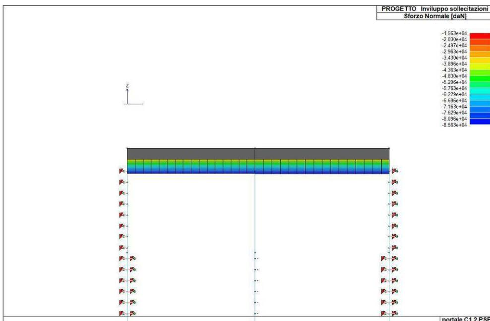
Figura 51. Involuppo dello sforzo normale del solettone di copertura
