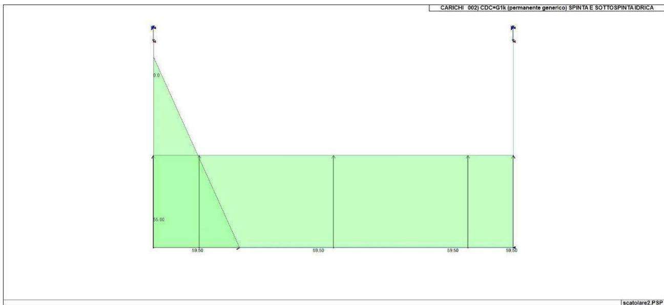
Figura 70. Caso di carico CDC 2 (Permanente spinta e sottospinta)
