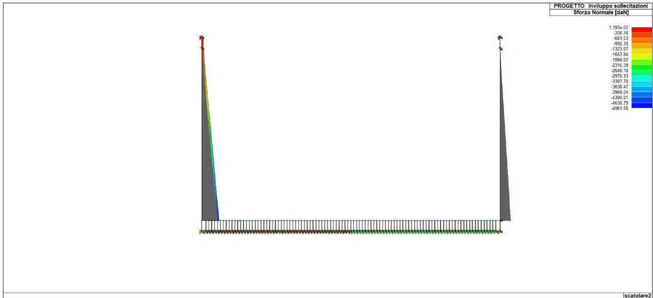
Figura 82. Involuppo dello sforzo normale delle fodere
