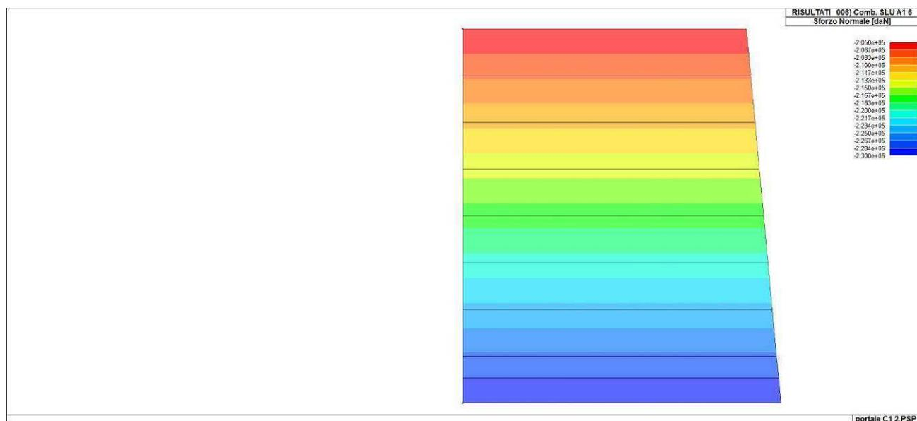
Figura 122. Sforzo normale massimo sul diaframma centrale
