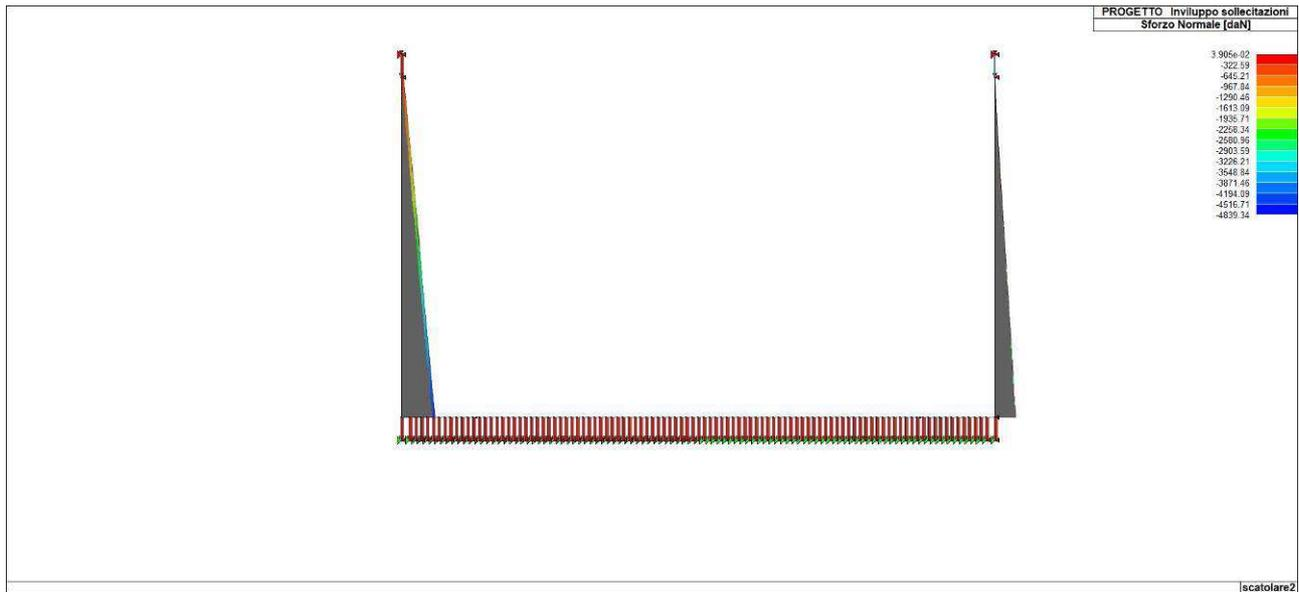
Figura 88. Involuppo dello sforzo normale delle fodere
