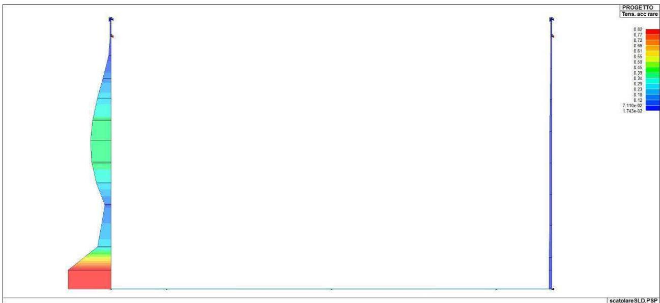
Figura 117. *Indice di verifica della tensione dell'acciaio per combinazioni rare*
