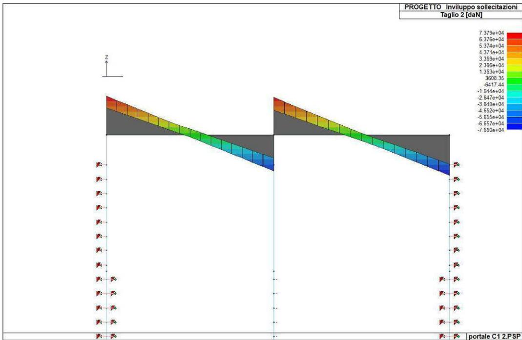
Figura 64. Inviluppo del taglio del solettone di copertura
