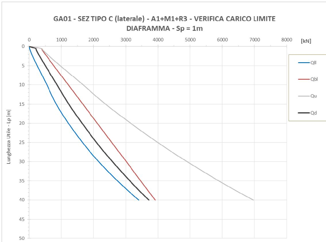
Figura 121. Curva di capacità portante diaframma laterale sezione C1
