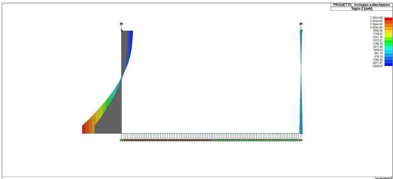
Figura 83. Involuppo del taglio delle fodere
