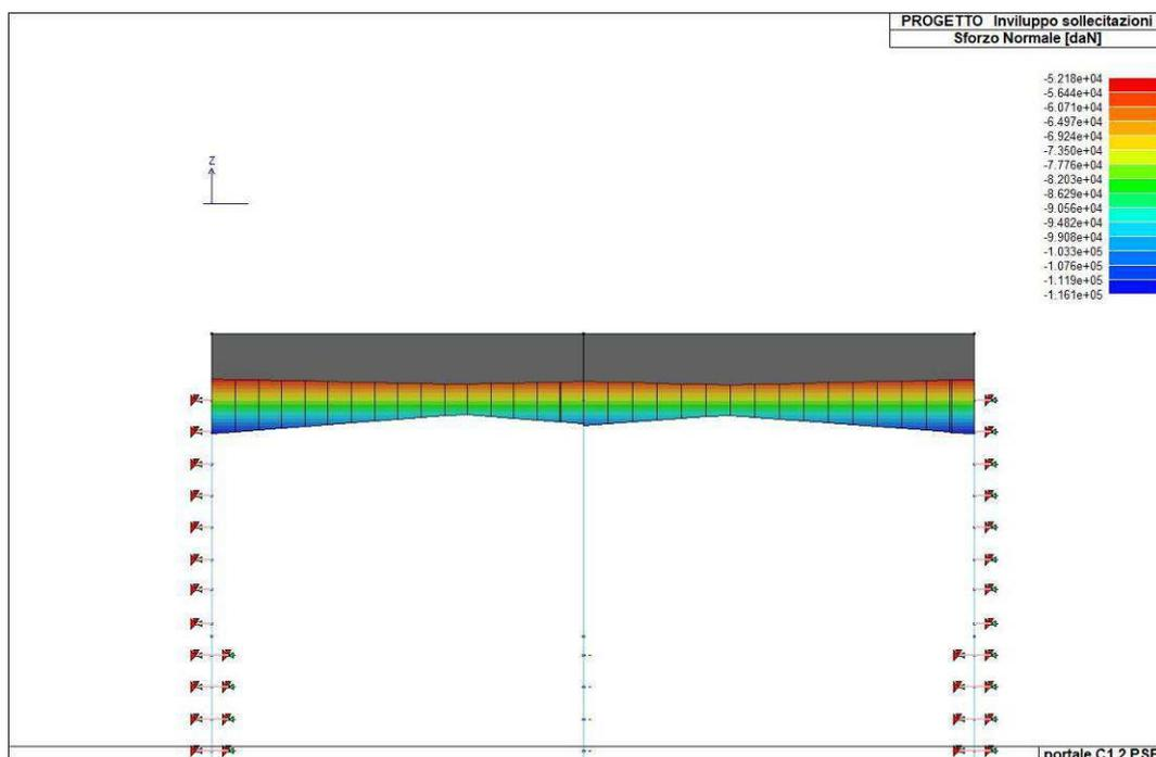
Figura 57. *Involuppo dello sforzo normale del solettone di copertura*
