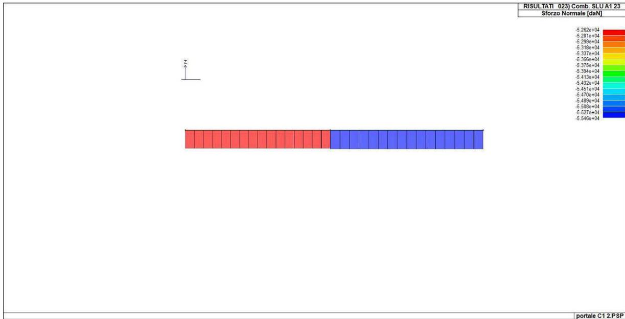
Figura 44. Sforzo normale solettone di copertura (combinazione 23)
