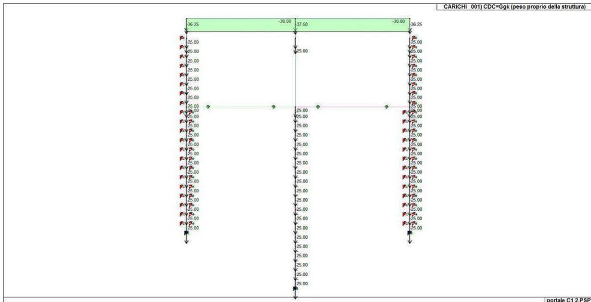
Figura 17. Caso di carico CDC 1 (peso proprio della struttura)
