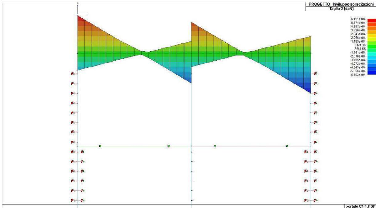
Figura 38. *Inviluppo del taglio del solettone di copertura*
