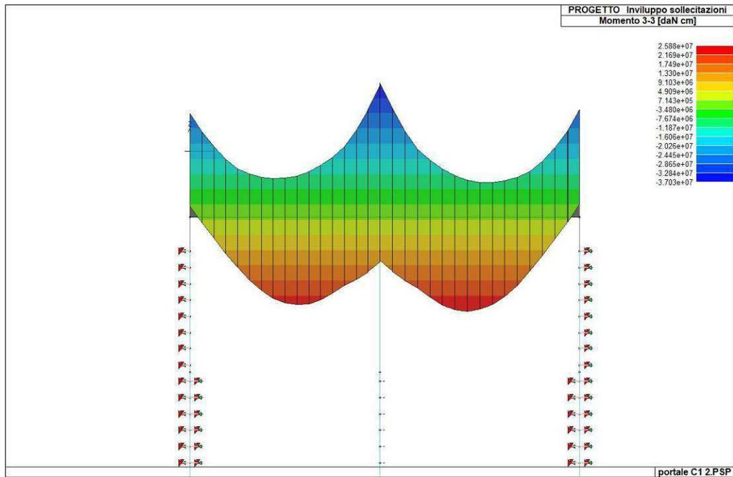
Figura 53. *Involuppo del momento flettente del solettone di copertura*
