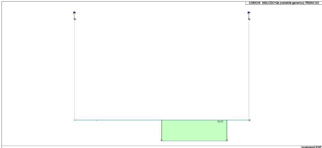
Figura 73. Caso di carico CDC 5 (Treno binario destra)
