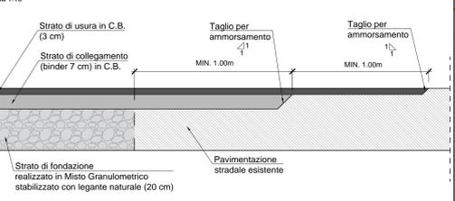
N.B. - LA VIABILITA' PROVVISORIA VERRA' REALIZZATA SULLA PAVIMENTAZIONE ESISTENTE, TRANNE CHE SULLE AREE INTERESSATE DALLE ISOLE DIVISIONALI E MARCIAPIEDI ESISTENTI IN CUI SI PROCEDERA' ALLA DEMOLIZIONE DI QUESTI ULTIMI ED ALLA ESECUZIONE DI UNA NUOVA PAVIMENTAZIONE STRADALE COME DA DETTAGLIO.
