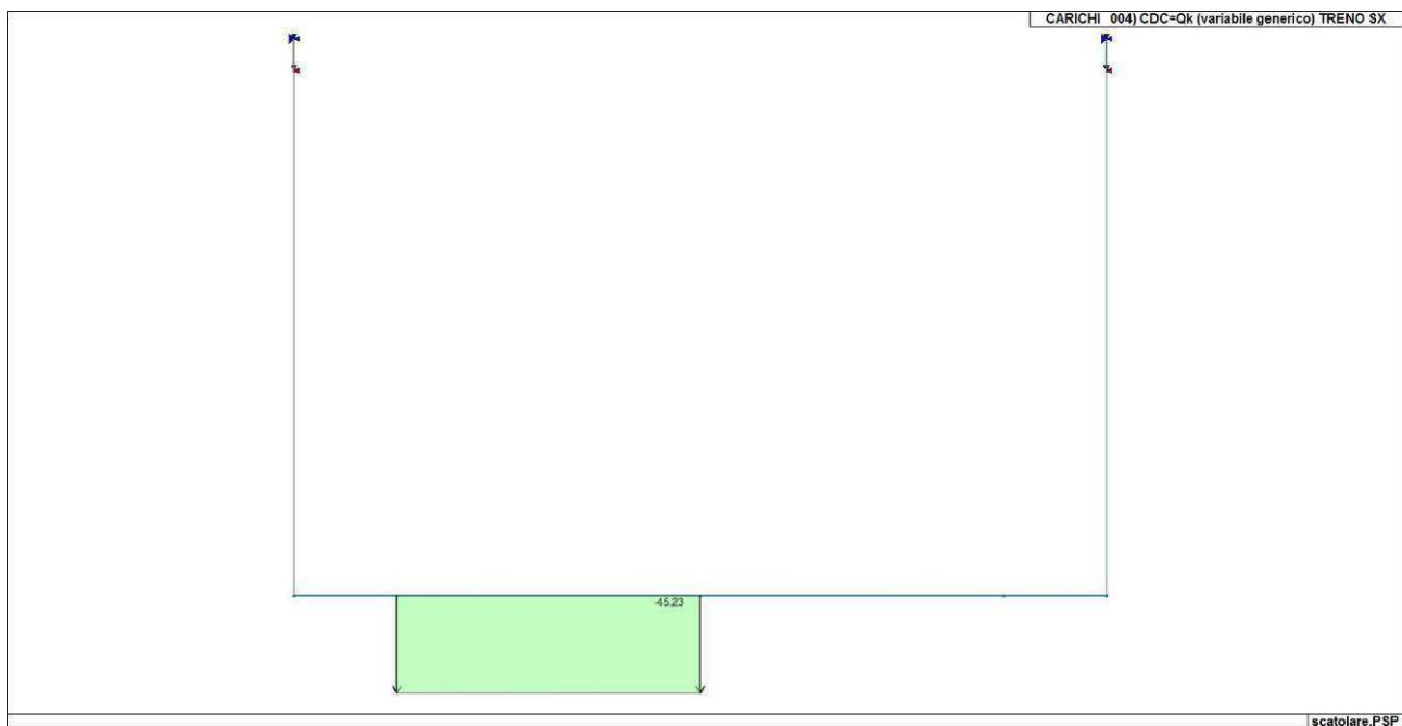
Figura 72. Caso di carico CDC 4 (Treno binario sinistra)
