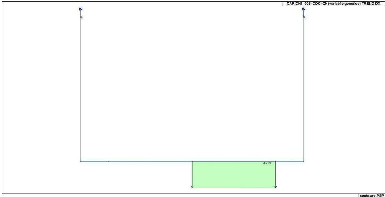
Figura 73. Caso di carico CDC 5 (Treno binario destra)
