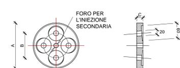
LE PIASTRE DI ANCORAGGIO REPERIBILI IN COMMERCIO DOVRANNO RISPONDERE ALLE SEGUENTI DIMENSIONI MASSIME E MINIME COMPATIBILI CON LA TESTATA DI ANCORAGGIO:
