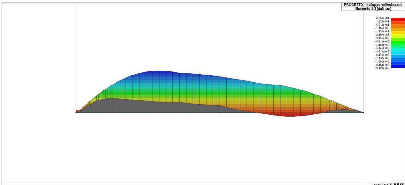
Figura 89. Involuppo del momento flettente del solettone di fondazione
