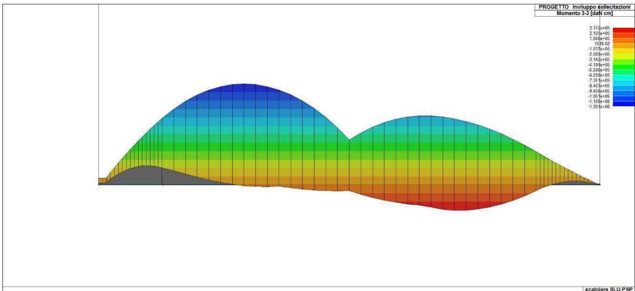
Figura 77. Inviluppo del momento flettente del solettone di fondazione
