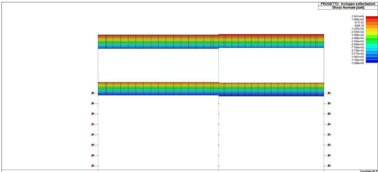
Figura 48. Involuppo dello sforzo normale del solettone di copertura
