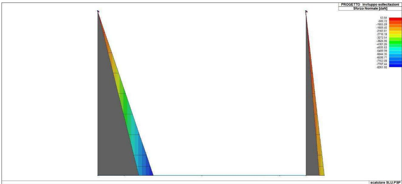
Figura 72. Inviluppo dello sforzo normale delle fodere
