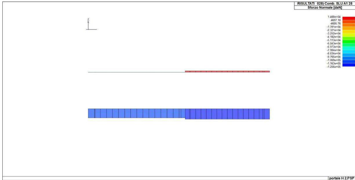
Figura 41. Sforzo normale solettone di copertura (combinazione 28)
