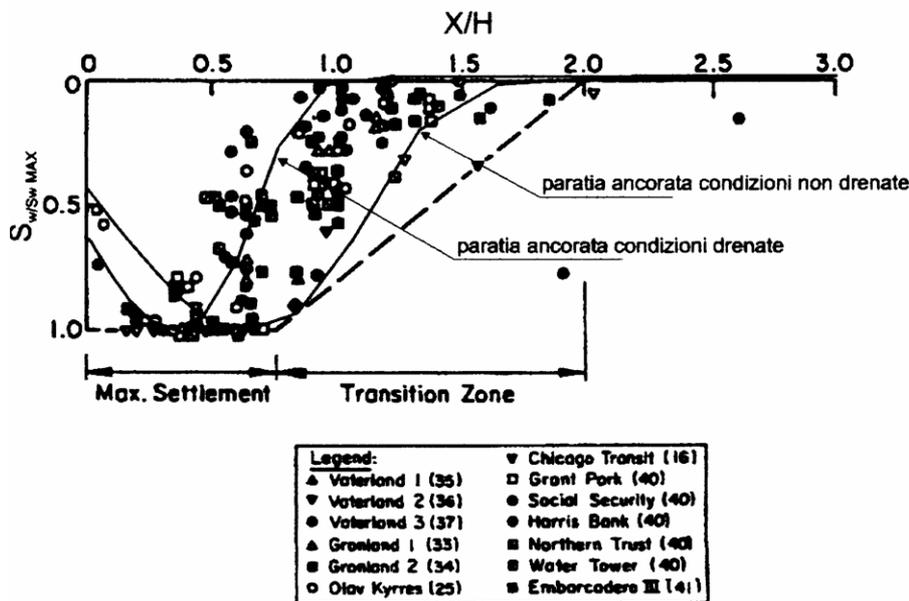
Figura 120. *Profili di subsidenza normalizzati (Pane & Tamagnini, 1997 Mana & Clough, 1981)*
