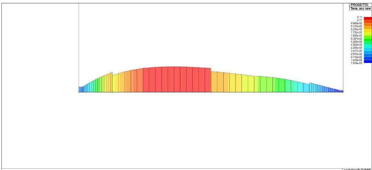
Figura 112. *Indice di verifica della tensione dell'acciaio per combinazioni rare*
