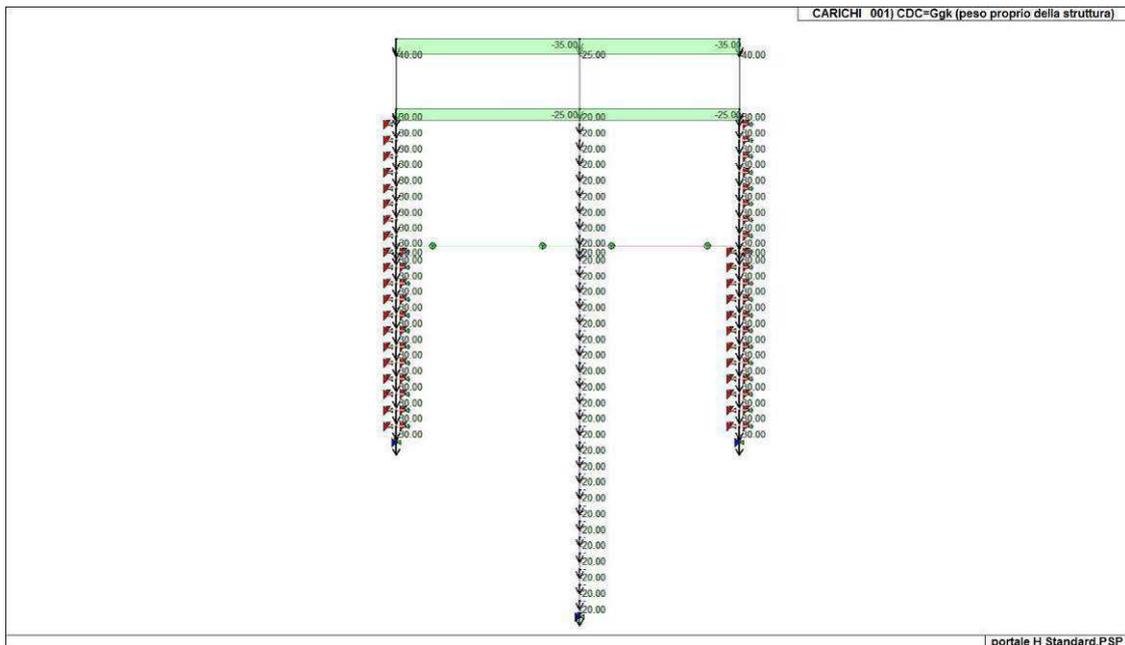
Figura 16. Caso di carico CDC 1 (peso proprio della struttura)
