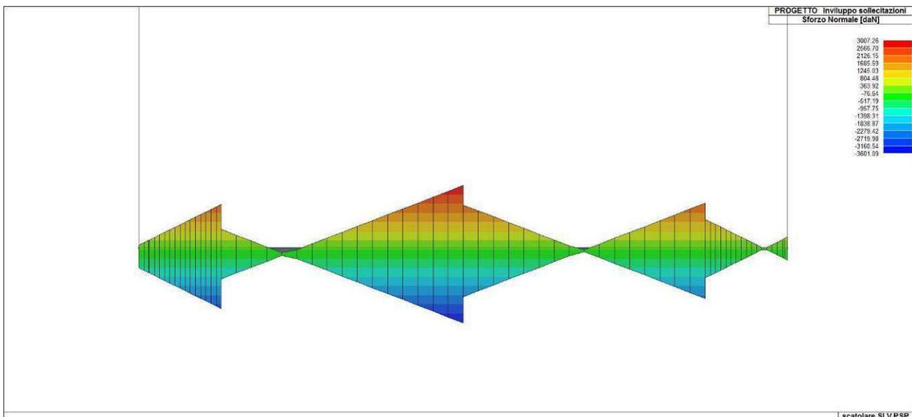
Figura 81. Involuppo dello sforzo normale del solettone di fondazione
