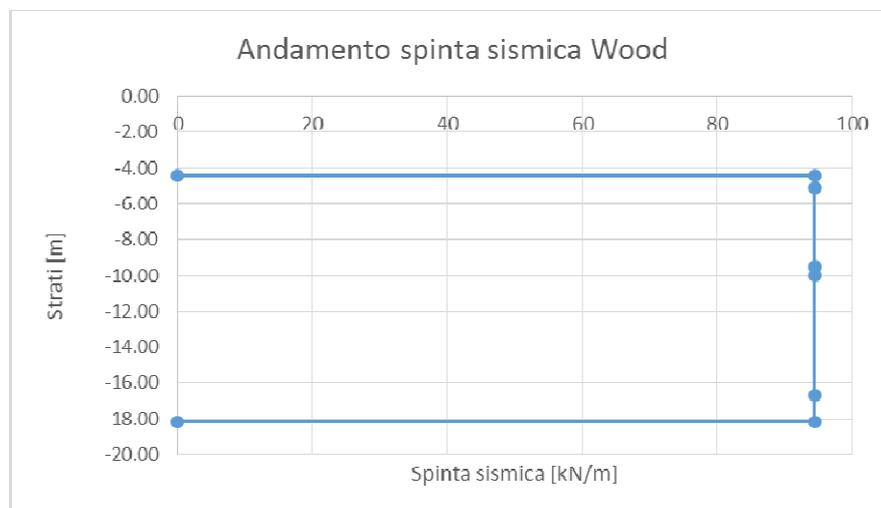
Figura 63. Diagramma andamento spinta Wood
