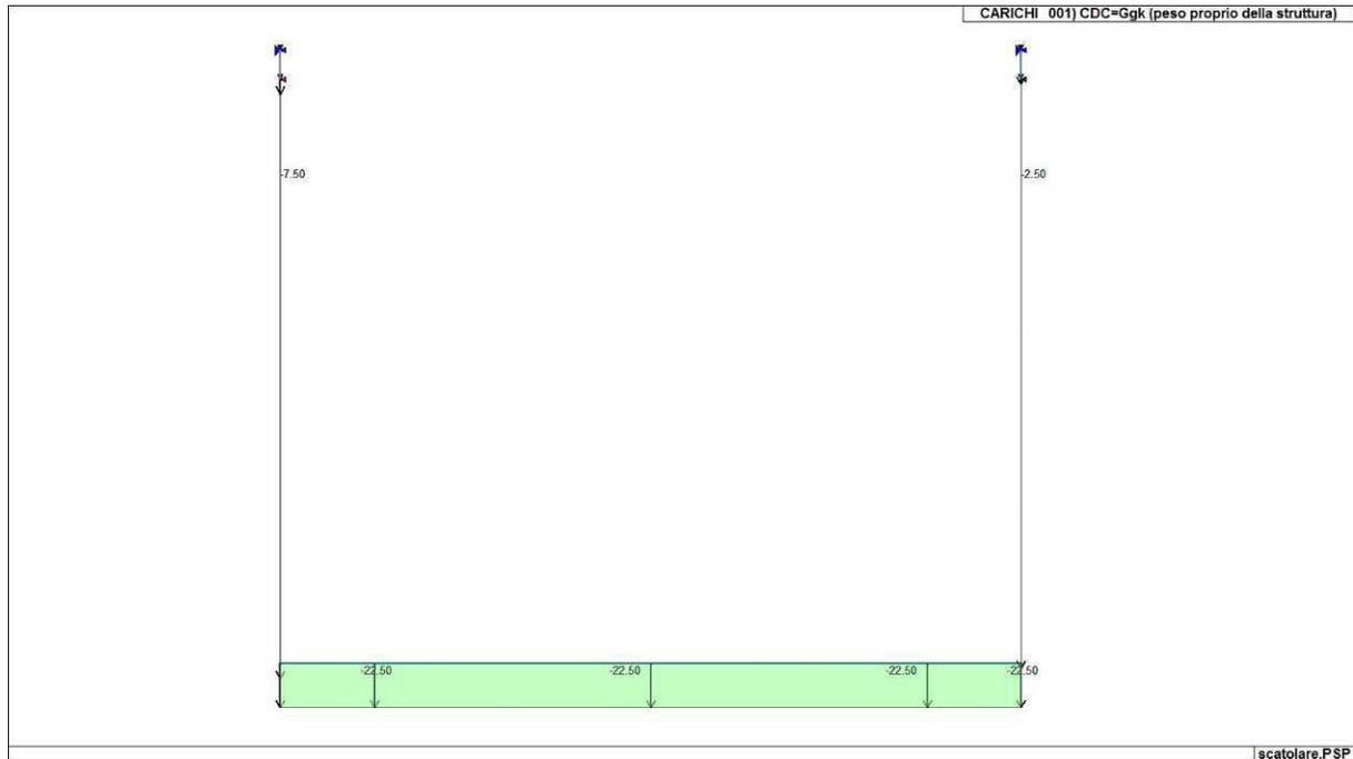
Figura 65. Caso di carico CDC 1 (Peso proprio della struttura)
