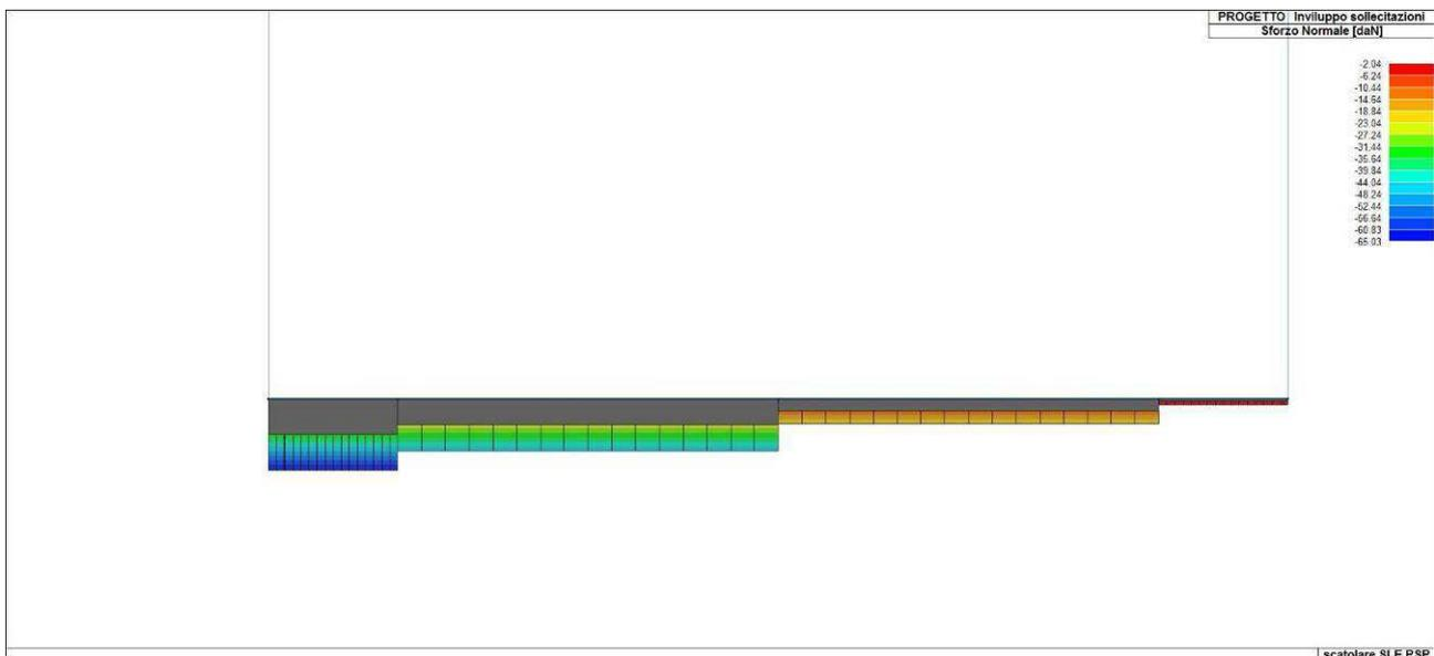
Figura 87. *Involuppo dello sforzo normale del solettone di fondazione*
