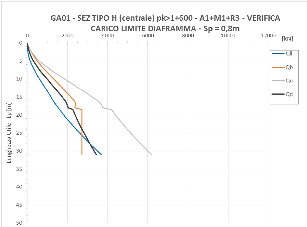
Figura 116. Curva di capacità portante diaframma centrale sezione H
