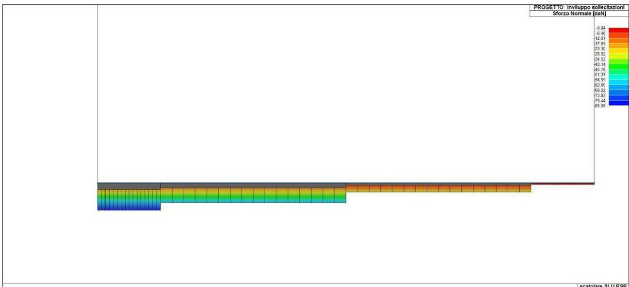
Figura 75. Involuppo dello sforzo normale del solettone di fondazione
