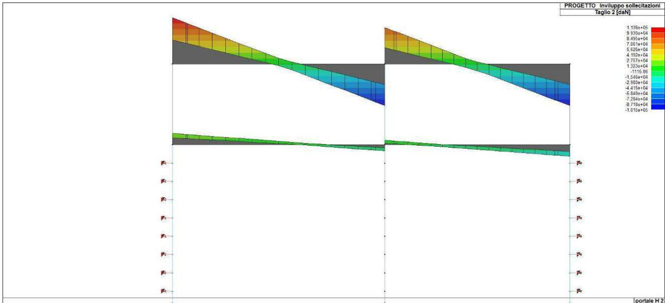
Figura 49. Inviluppo del taglio del solettone di copertura
