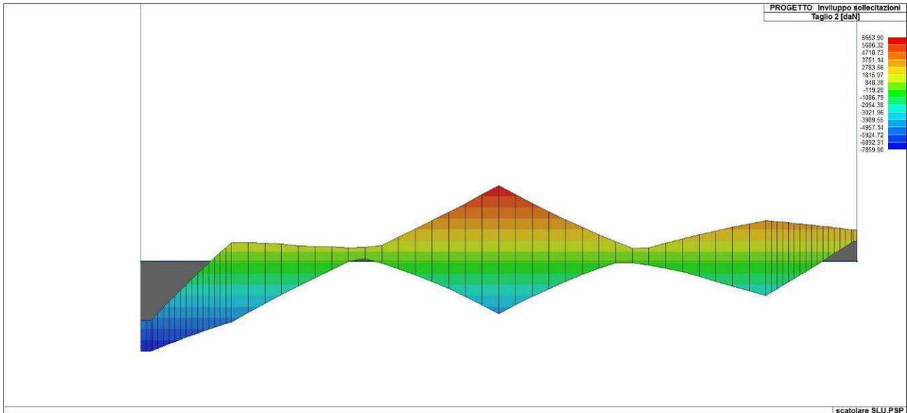
Figura 76. Inviluppo del taglio del solettone di fondazione
