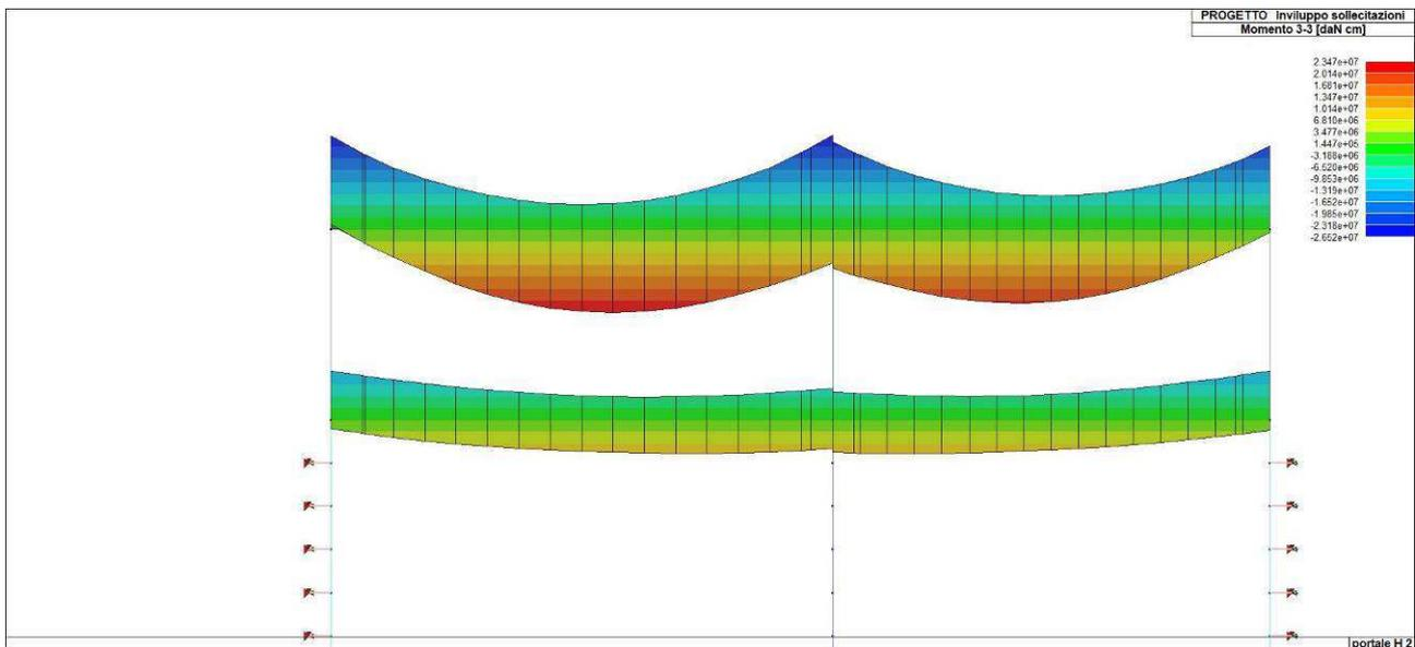
Figura 62. *Inviluppo del momento flettente del solettone di copertura*
