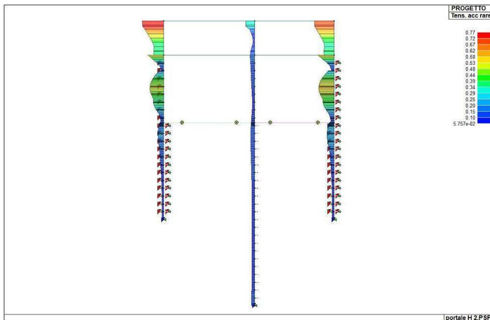
Figura 106. *Indice di verifica della tensione dell'acciaio per combinazioni rare*
