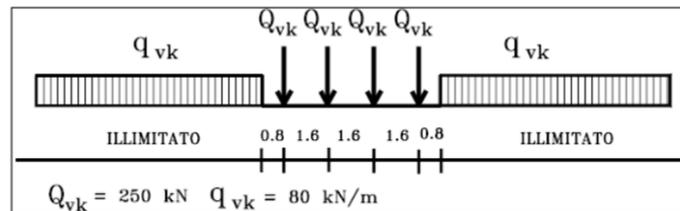
In direzione longitudinale i carichi concentrati vengono considerati come uniformemente ripartiti. In direzione trasversale i carichi vengono ripartiti, a partire da una dimensione pari alla larghezza della traversa (2,40 m per la galleria di sinistra) fino al piano medio del traverso di fondazione dello scatolare, adottando una diffusione 4:1 all'interno dello strato di ballast e di 1:1 nello strato di calcestruzzo della fondazione stessa.
