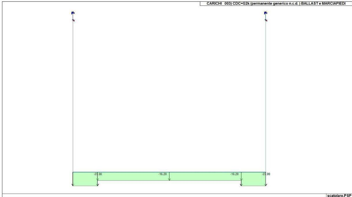
Figura 67. Caso di carico CDC 3 (Permanente ballast e marciapiedi)
