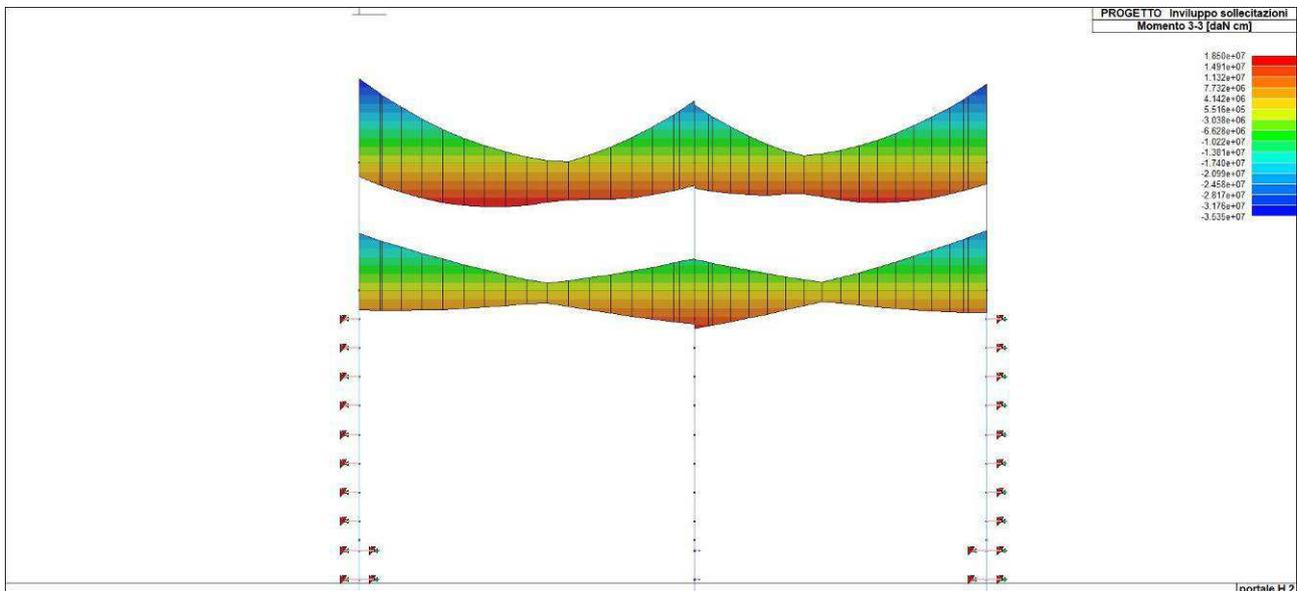
Figura 56. Inviluppo del momento flettente del solettone di copertura
