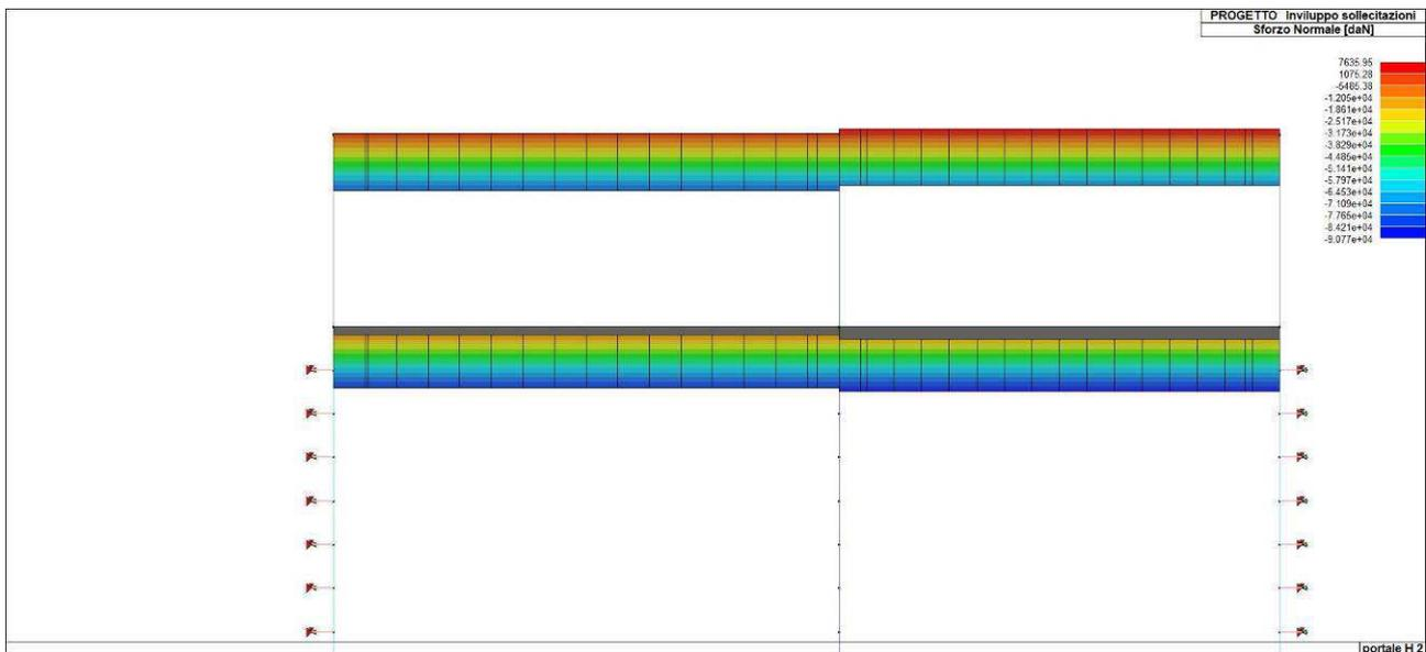
Figura 60. Involuppo dello sforzo normale del solettone di copertura
