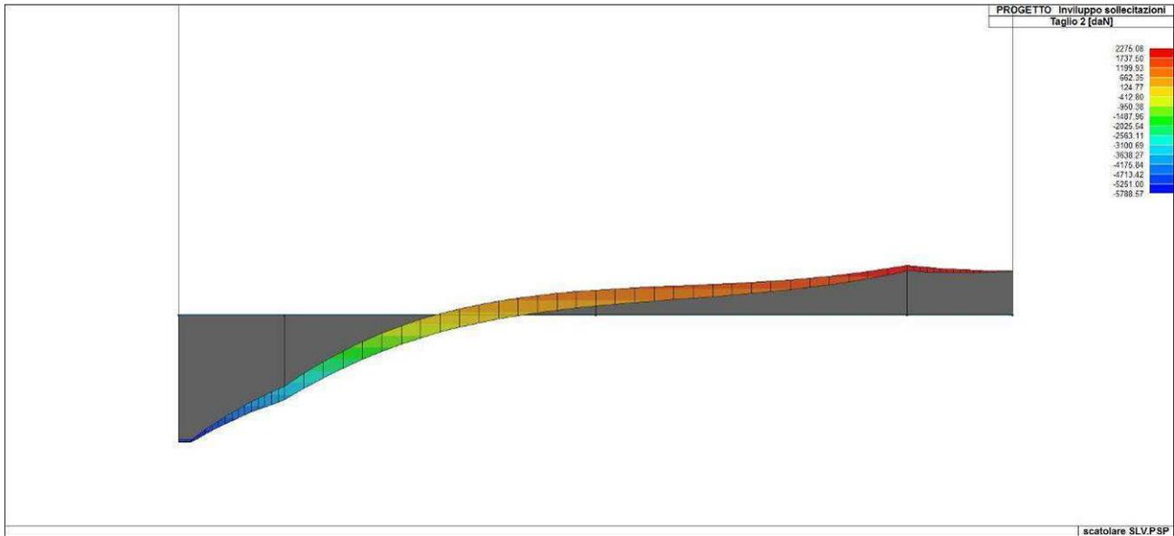
Figura 82. Involuppo del taglio del solettone di fondazione
