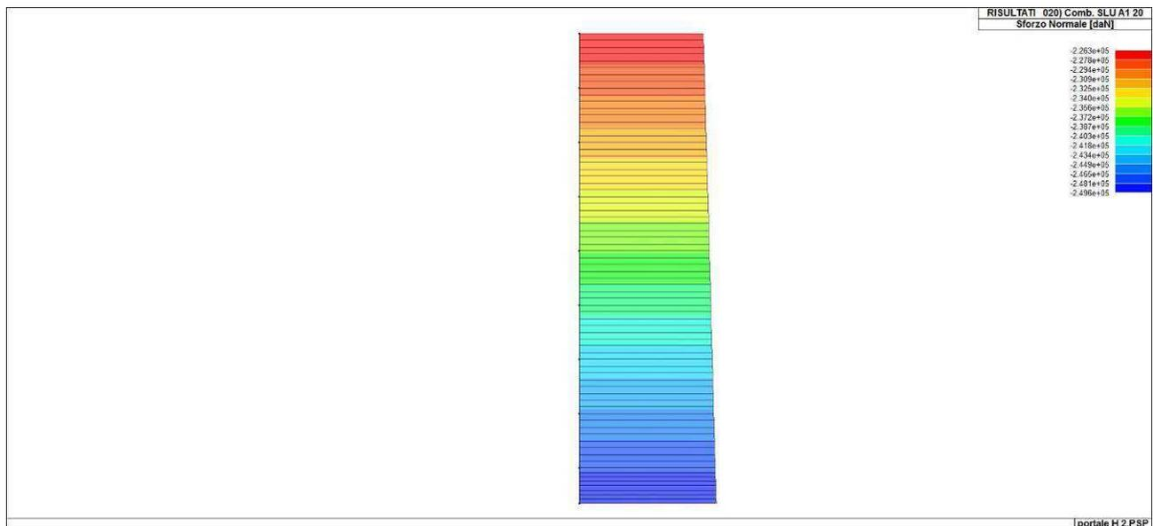
Figura 115. Sforzo normale massimo sul diaframma centrale
