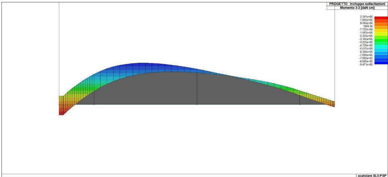
Figura 83. Involuppo del momento flettente del solettone di fondazione
