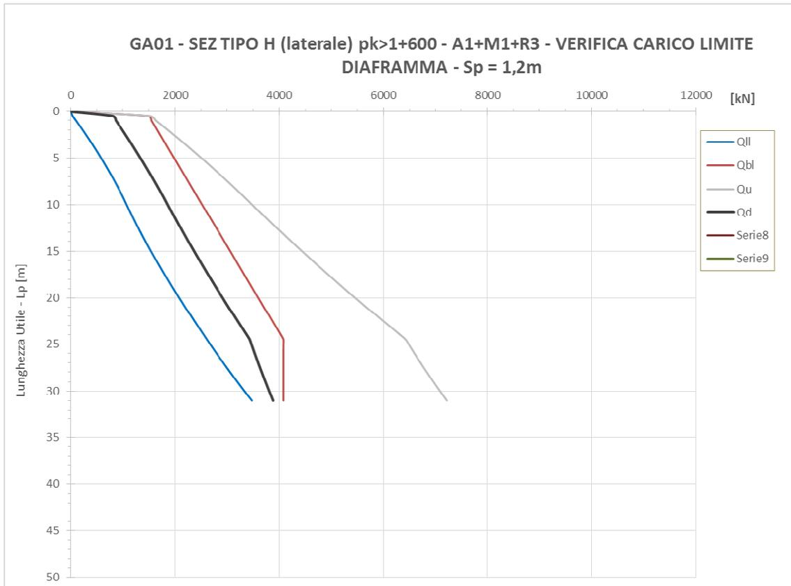
Figura 114. *Curva di capacità portante diaframma laterale sezione H*
