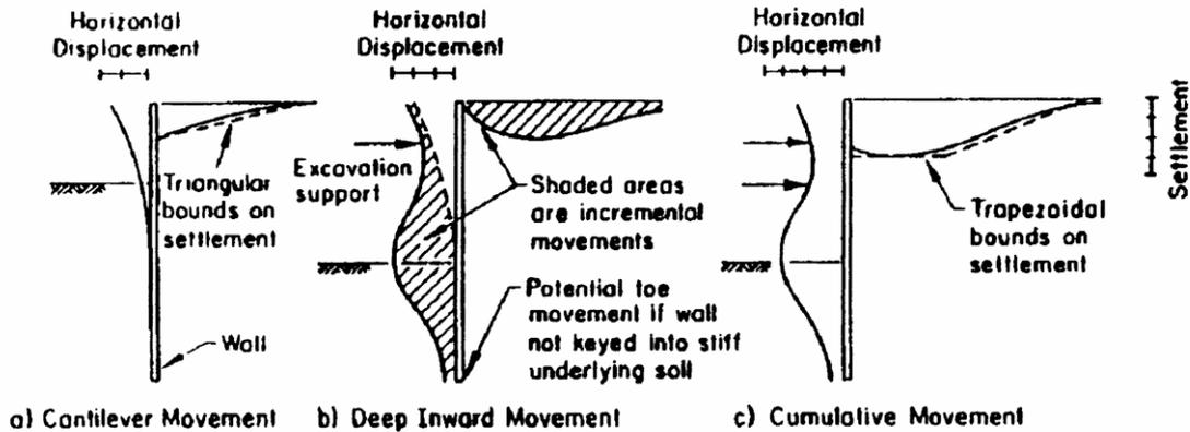
Figura 117. Cinematismi tipo (Clough & O'Rourke, 1990)
