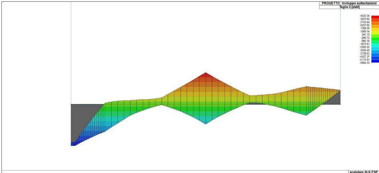
Figura 88. Involuppo del taglio del solettone di fondazione
