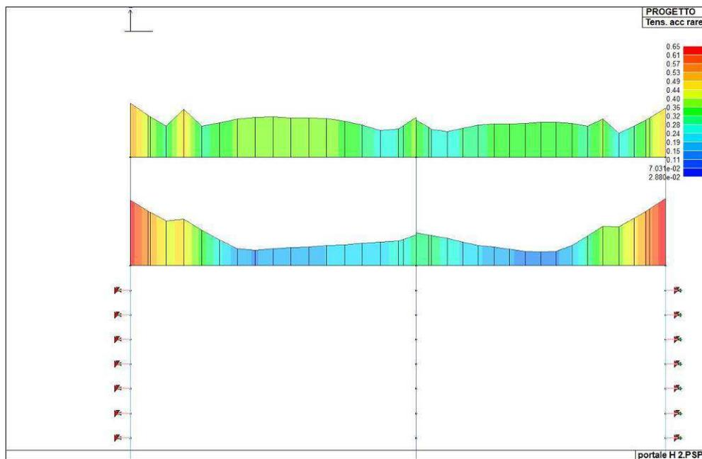
Figura 108. *Indice di verifica della tensione dell'acciaio per combinazioni rare*
