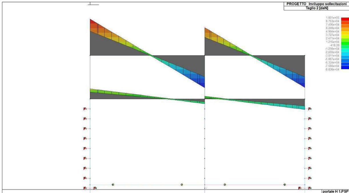
Figura 35. *Inviluppo del taglio del solettone di copertura*
