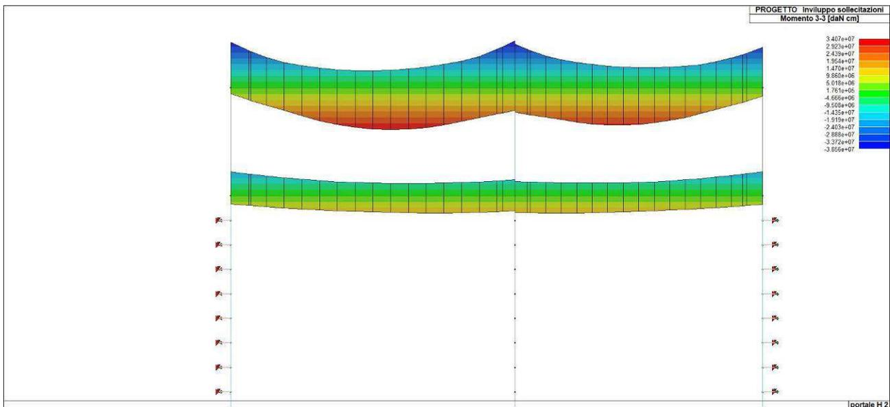
Figura 50. Inviluppo del momento flettente del solettone di copertura
