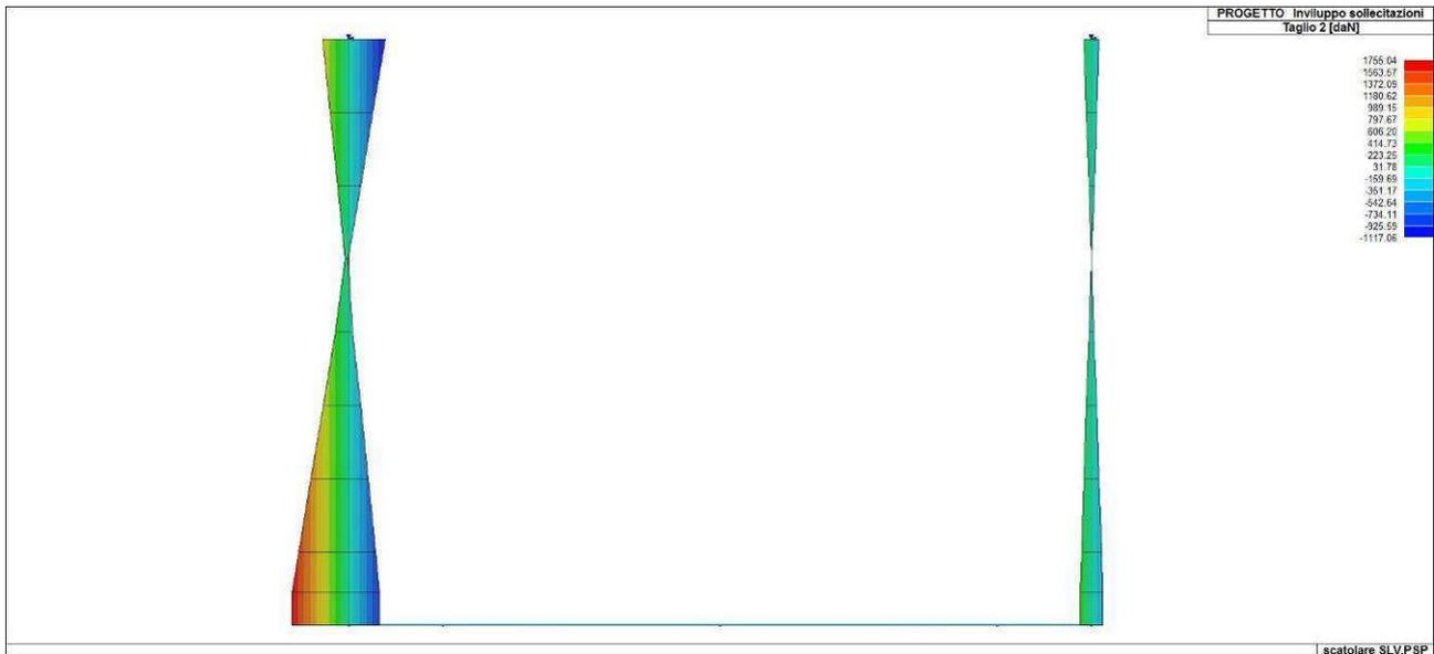
Figura 79. Involuppo del taglio delle fodere
