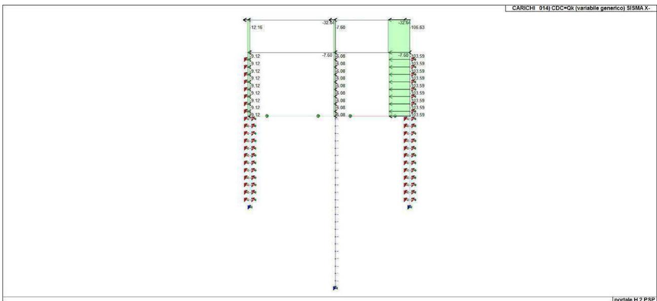
Figura 29. Caso di carico CDC 14 (Sisma X-)
