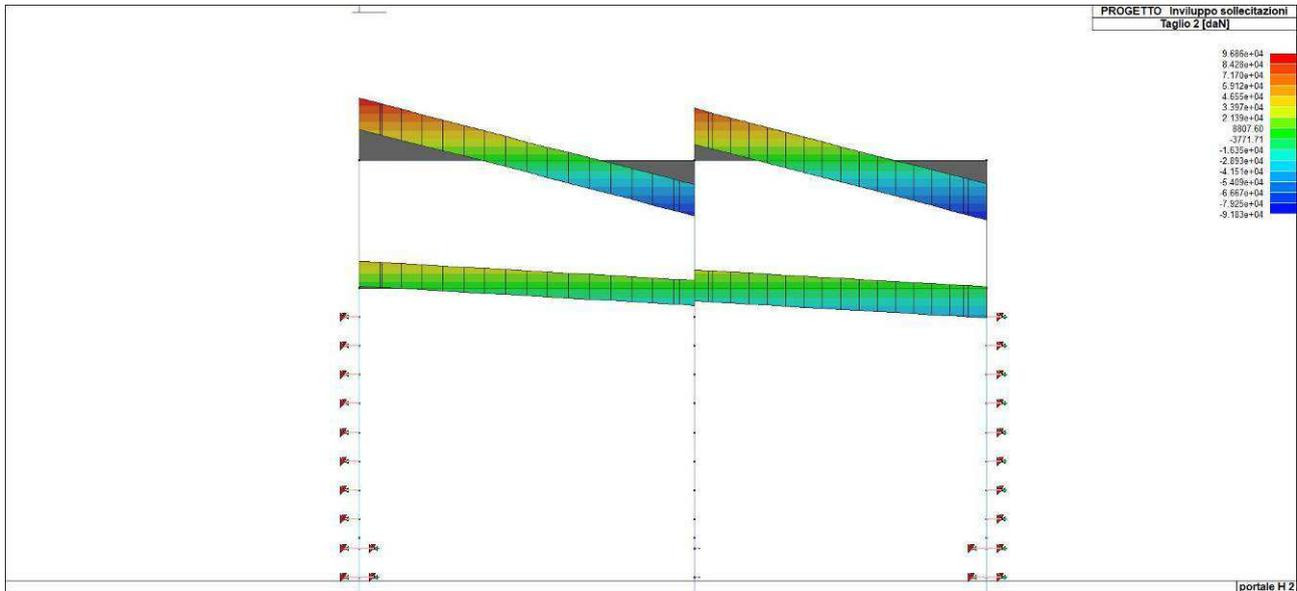
Figura 55. Inviluppo del taglio del solettone di copertura
