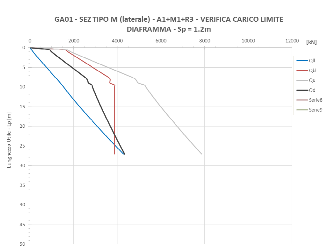
Figura 115. Curva di capacità portante diaframma laterale sezione M
