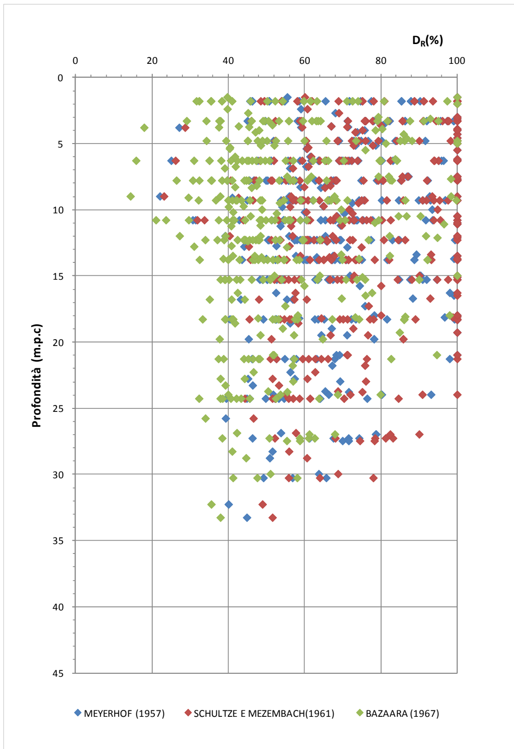
F 47. Valori della densità relativa D_R (Meyerhof [1957] Schultze e Mezembach [1961] Bazaara [1967]) – T_{cm_1}
