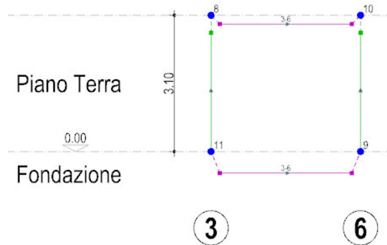
Figura 28: Numerazione dei nodi e delle aste del modello di analisi – Telaio trasversale 3
