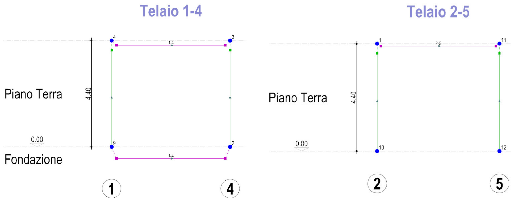
Figura 41: Numerazione dei nodi e delle aste del modello di analisi – Telai trasversali 1-2
