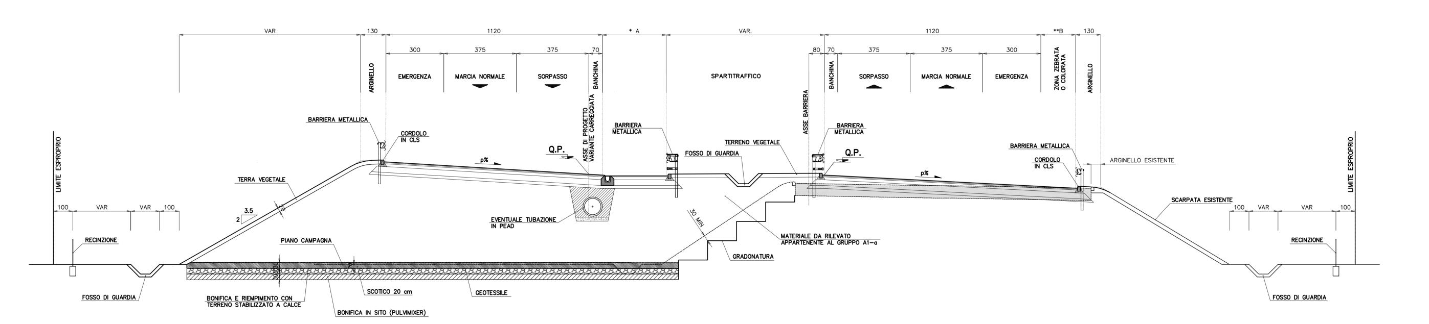
\* A = allargamento per visibilità dello spartitraffico in curva sx \*\* B = allargamento per visibilità del margine esterno in curva dx
