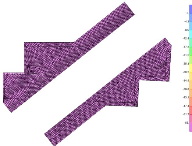
**Figura 7 – Carichi permanenti sulla soletta inferiore**
