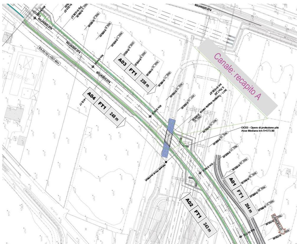
Figura 5 - Stralcio planimetria drenaggio piattaforma ferroviaria afferente al canale in oggetto
