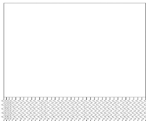
**Figura 6 Schematizzazione elementi frame e molle**
