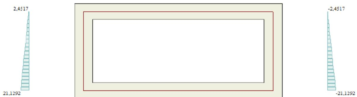
Figura 6 – Spinte della falda (kPa)
