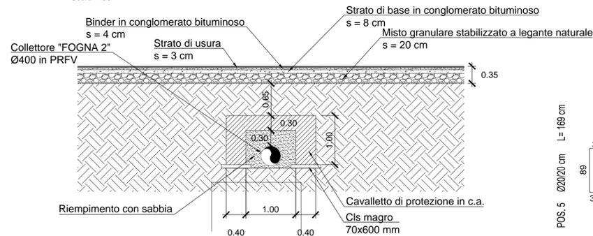
**PARTICOLARE POZZETTO DI ISPEZIONE TIPO**
