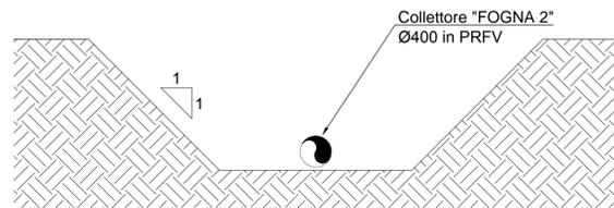
**SEZIONE TIPO A-A - FASE DI PROGETTO**
