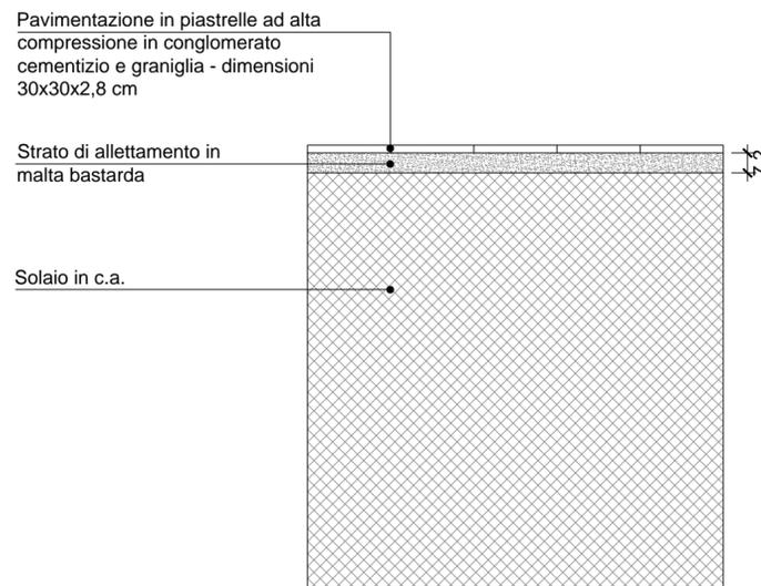
**B3.1 - PAVIMENTAZIONE CENTRALI DI VENTILAZIONE**
