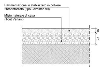
**T1 - PAVIMENTAZIONE ESTERNA IN STABILIZZATO**
