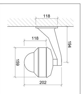
QUOTATURA TELECAMERA IP TIPO SPEED DOME
